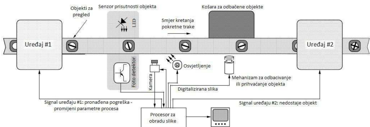
Slika 2.2 Primjer komunikacije vizijskog sustava s okolinom [4]
