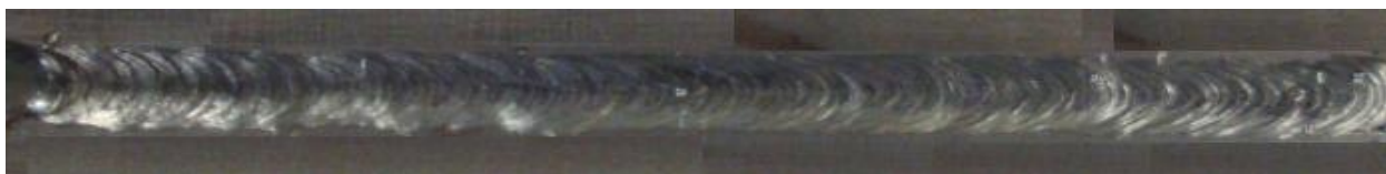
Slika 34. Pokus P2M, lice zavora.
