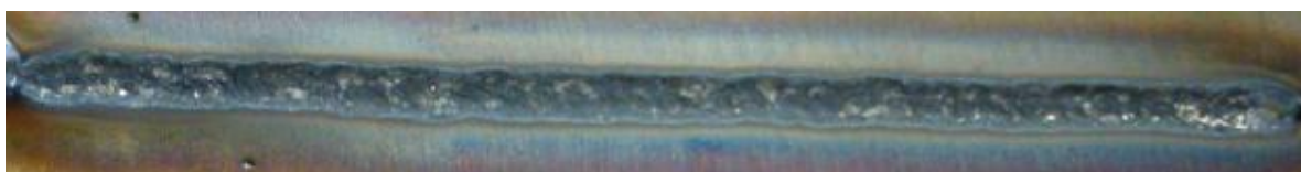
Slika 39. Pokus P4M, korijen zavara.
