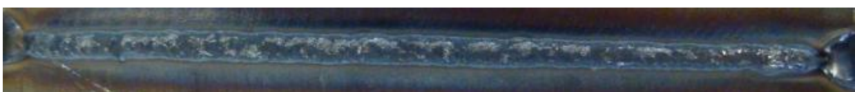
Slika 33. Pokus P1M, korijen zavara.
