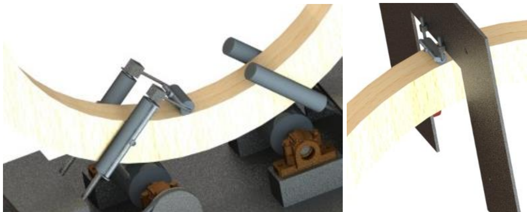
Slika 80. Koncept 2A - sustav za lijepljenje
