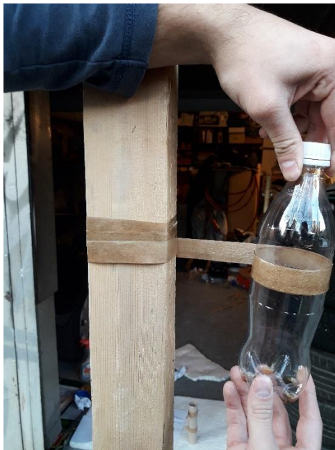
Slika 92. Prvi način - namatanje papira na predložak
