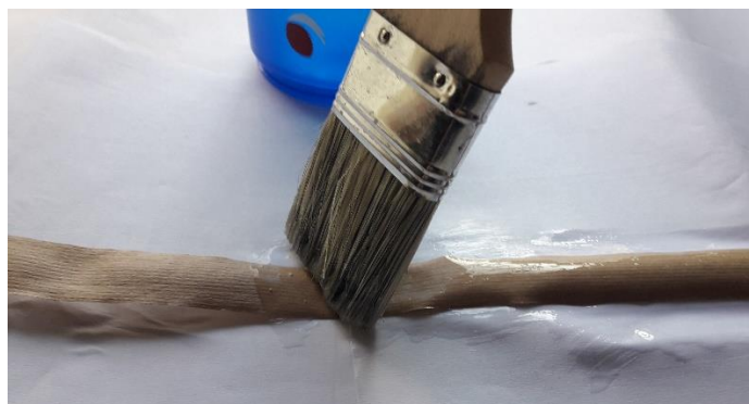
Slika 93. Drugi način - nanošenje ljepila pomoću kista
