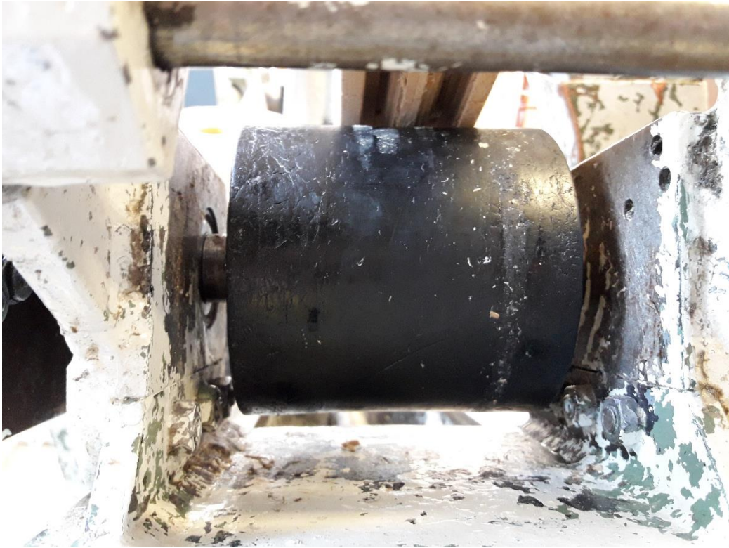
Slika 31. Ostaci ljepila na okretnom bubnju
