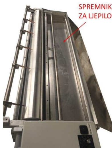
Slika 54. Datco Cold Roll aplikator - prikaz spremnika za ljepilo
