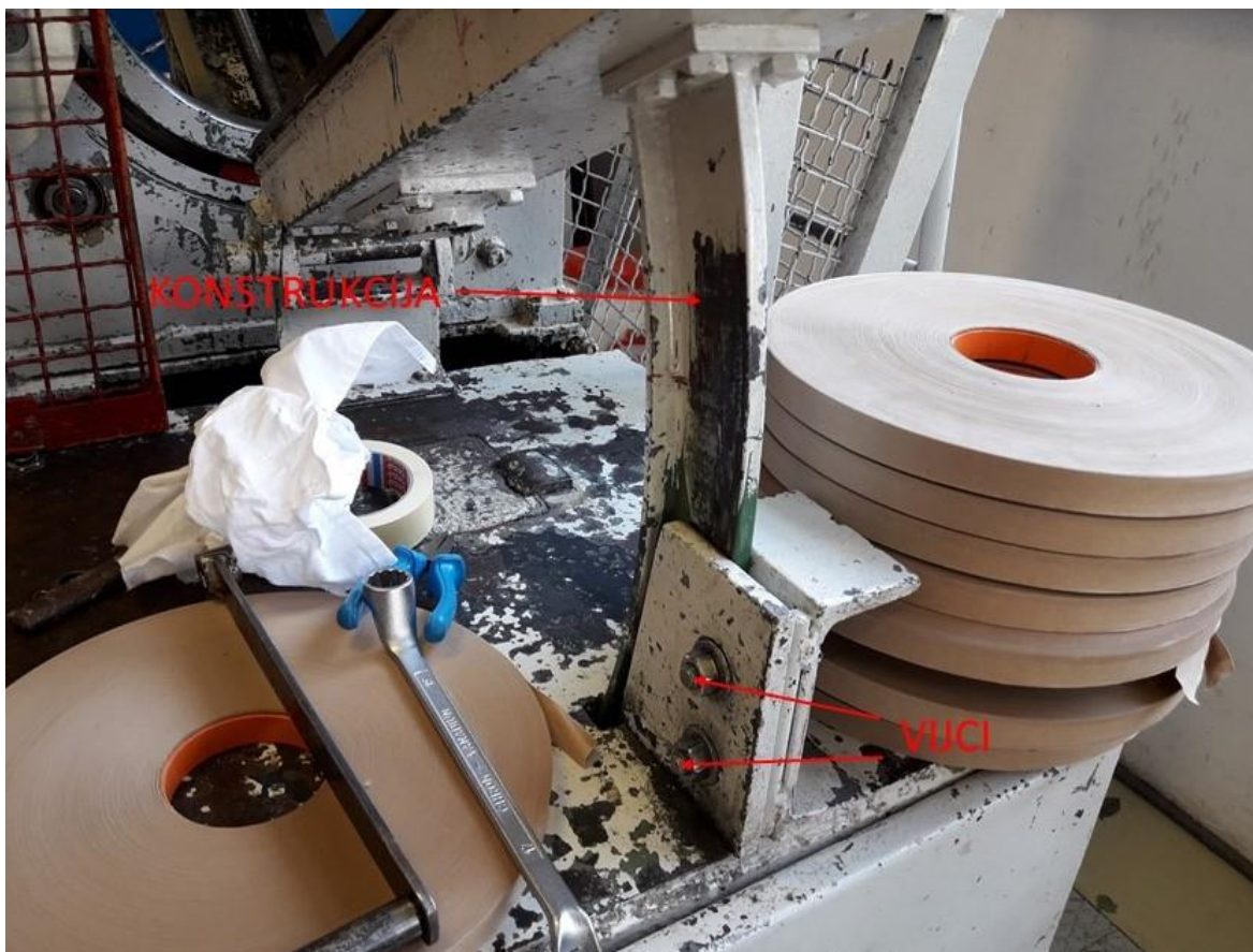
Slika 30. Vijci koji drže konstrukciju
