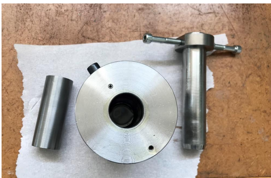
Slika 28. Alat u kojem se nalazi uzorak tijekom prešanja
