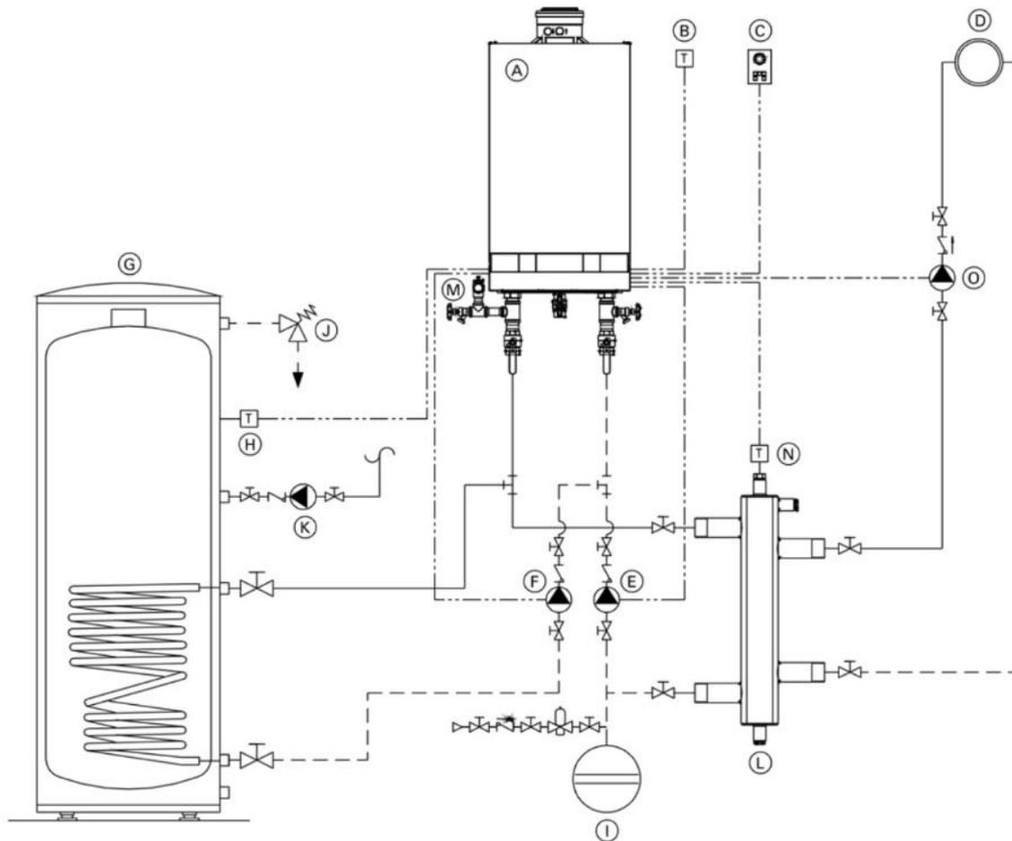
Slika 1-9. Centralno grijanje uz pomoć toplovodnog kotla [4]
