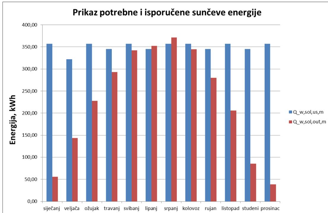
Slika 8-2. Usporedba potrebne energije za grijanje PTV-a i isporučene energije solarnog sustava po mjesecima
