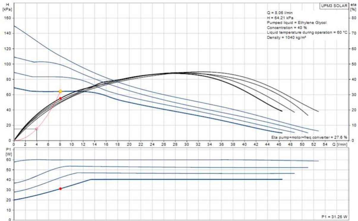
Slika 8-6. Radne krivulje pumpe "Grundfos UPM3 SOLAR 15-145 130 CZA" solarnog sustava [13]
