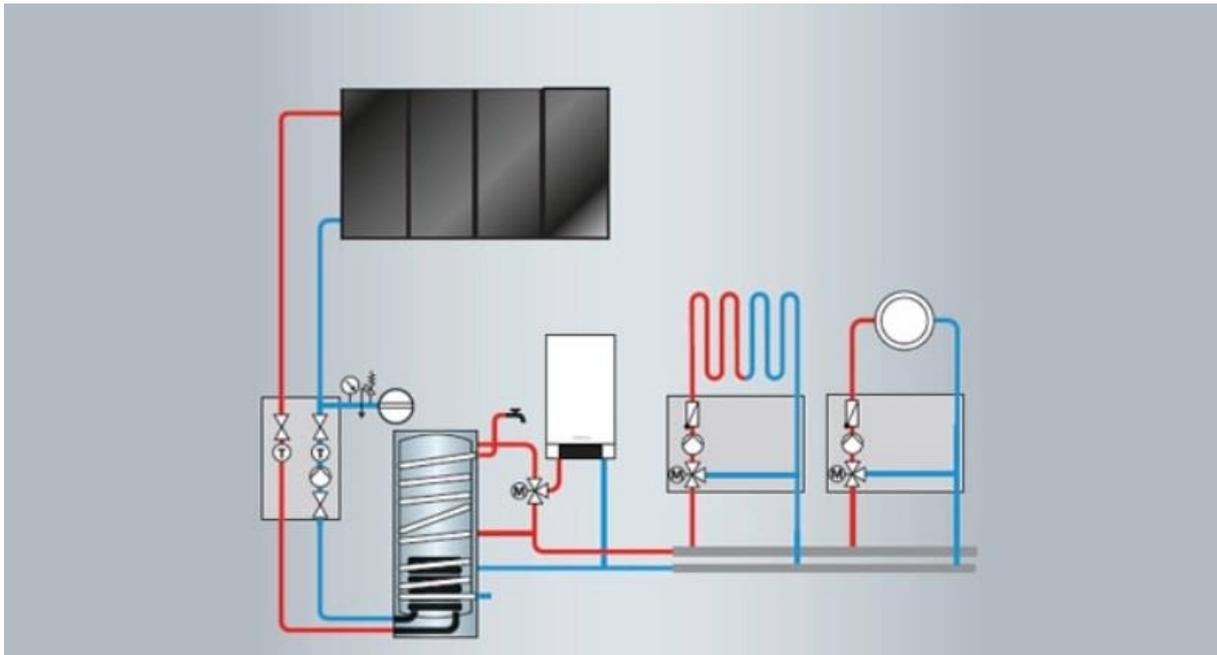
Slika 1-10. Centralno grijanje sa kotlom i solarnim sustavom [3]
