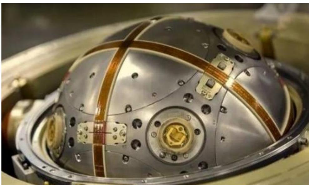
**Slika 12: Inercijalni navigacijski uređaj balističke rakete [1]**
