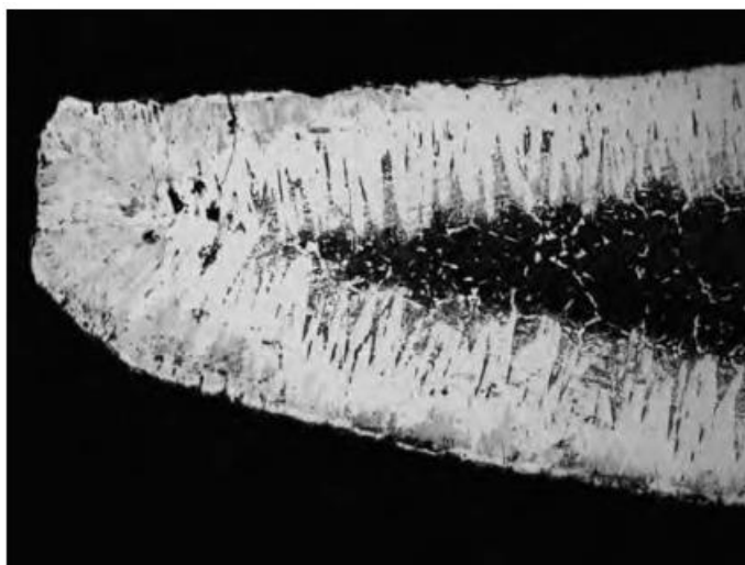
Slika 9. Nastajanje FeB faze na vrhu oštrice [4]
