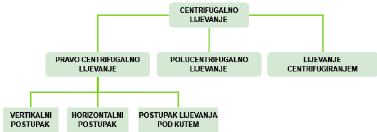
Slika 2.7 Postupci centrifugalnog lijevanja
