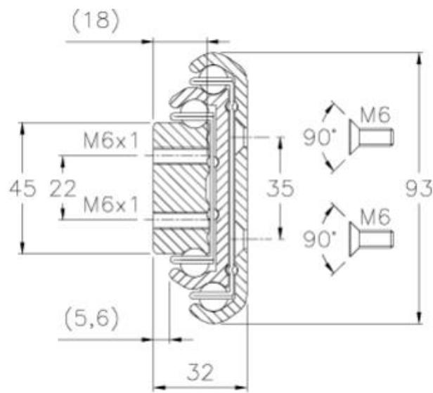
Slika 18. Prikaz fiksiranja vodilice[10]
