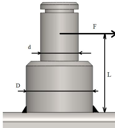
**Slika 24. Opterećenje zavara**
