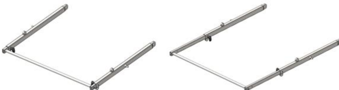
Slika 21. Sklop ručke u uvučenom i izvučenom položaju
