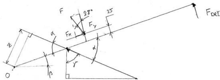
**Slika 27. Prikaz djelovanja sile na mehanizam podizanja**
