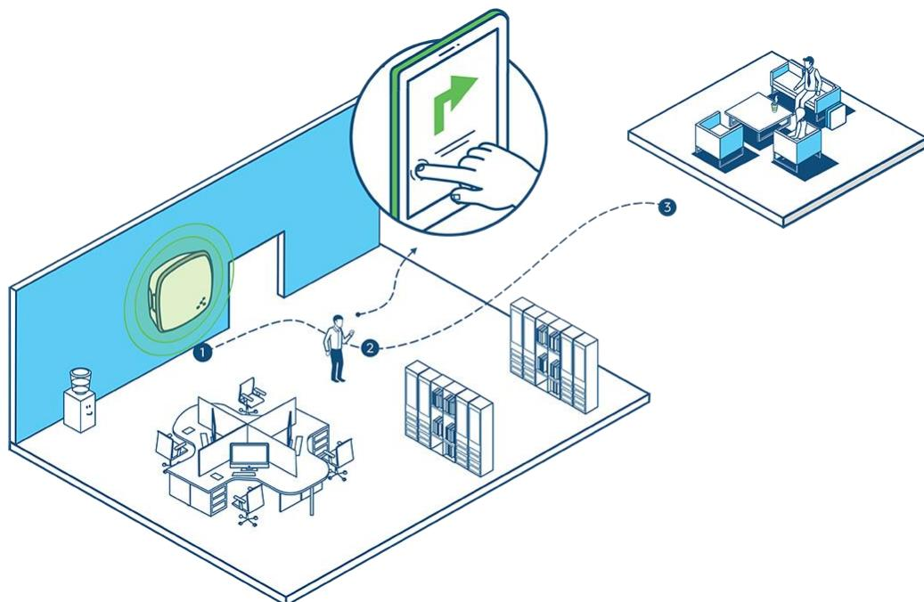
Slika 15. Primjer upotrebe beacon uređaja za unutarnju navigaciju [28]
