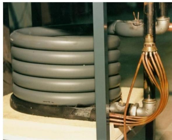
Slika 9. Koaksijalni isparivač eksperimentalnog rashladnog uređaja [3]
