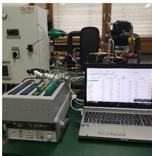
**Slika 17. Akvizicijski sustav s A/D pretvaračem**
