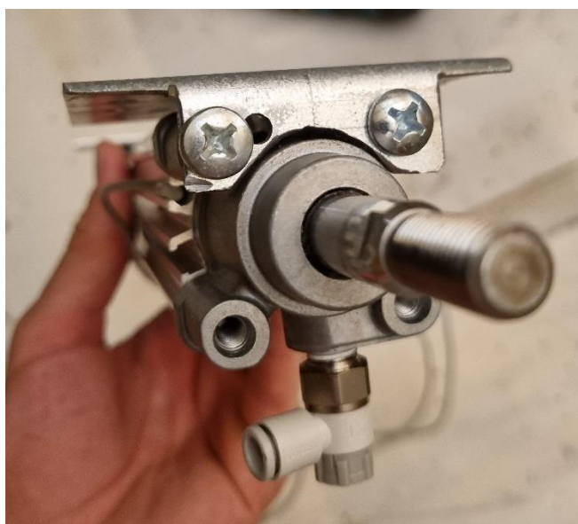
Slika 25. Kutni profil za pričvršćivanje cilindra
