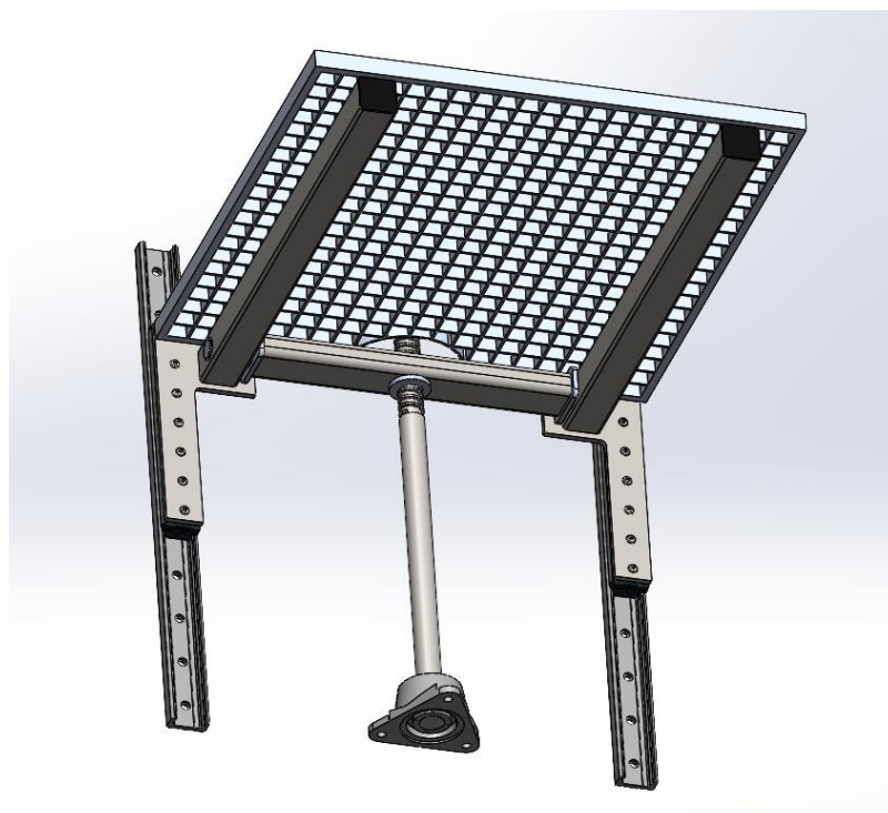
Slika 6. Donji pogled 3D modela pokretnog dijela gazišta
