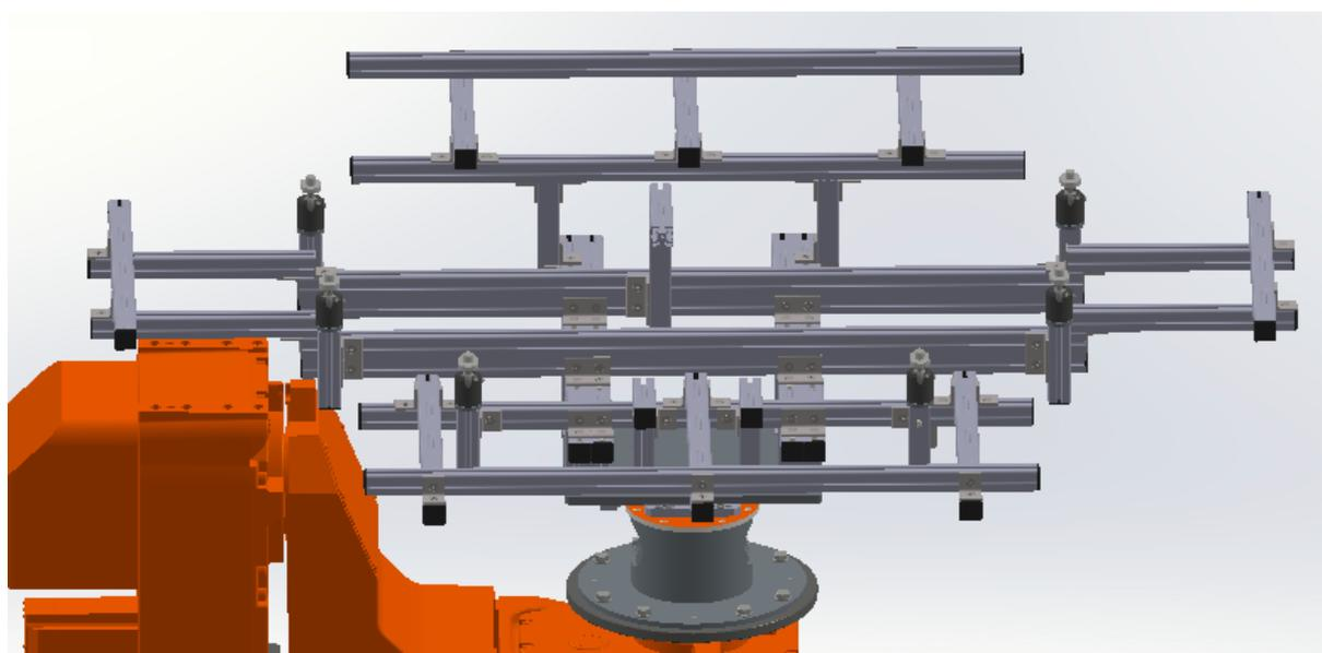
**Slika 23. Raspored elemenata za centriranje po konstrukciji**
