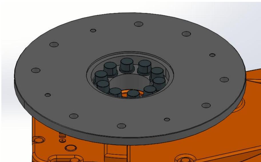
Slika 15. Standardna robotska prirubnica promjera 450 mm
