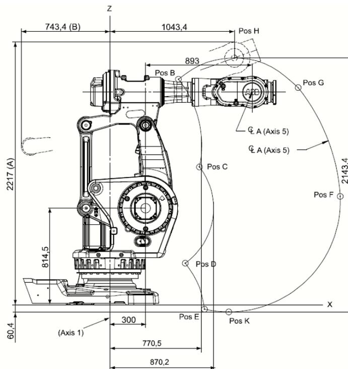
Slika 3. Doseg robota IRB6660-205/1.9 [4]
