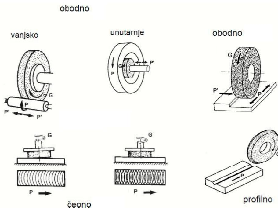
Slika 5. Podijela postupka brušenja [7]
