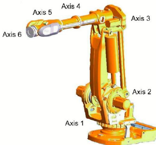
**Slika 2. Zglobovi robota [4]**
