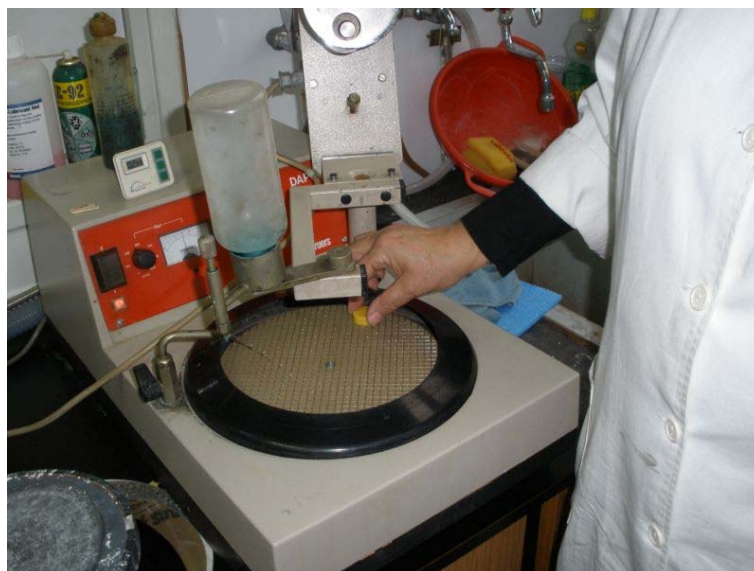
Slika 6. Uređaj za brušenje i poliranje keramike
