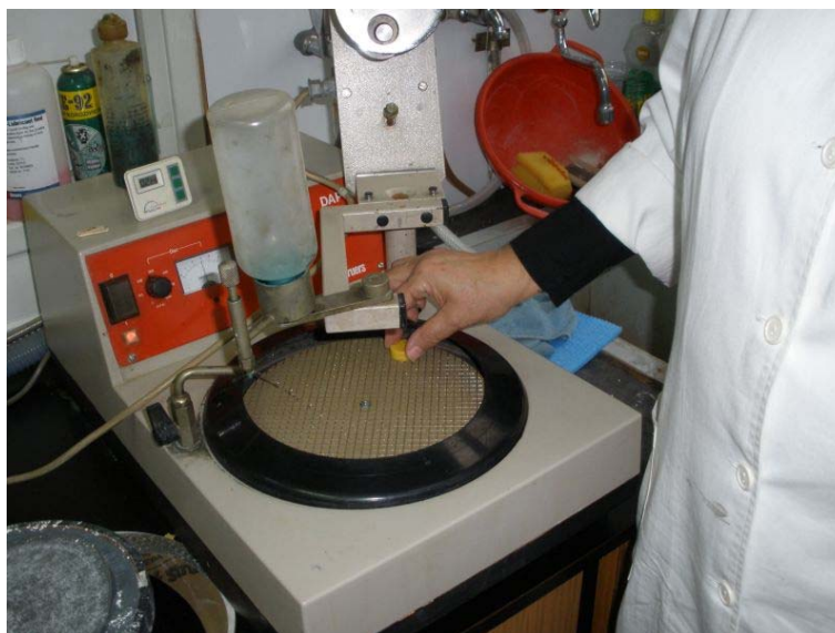
Slika 6. Uređaj za brušenje i poliranje keramike
