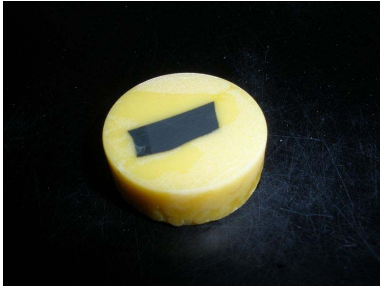
Slika 5. Izgled uzorka nakon zalijeivanja
