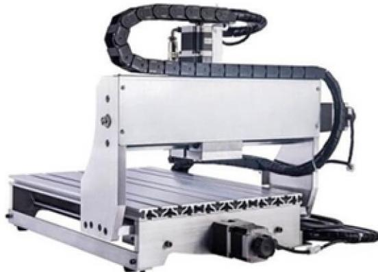
Slika 8 Mini CNC 3040 niskobudžetna tro-osna CNC glodalica [9]
