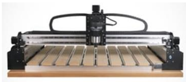
Slika 10. Carbide 3D Shapeoko 4 niskobudžetna tro-osna CNC glodalica [11]
