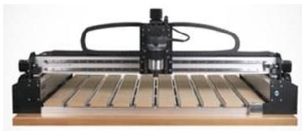
Slika 10. Carbide 3D Shapeoko 4 niskobudžetna tro-osna CNC glodalica [11]
