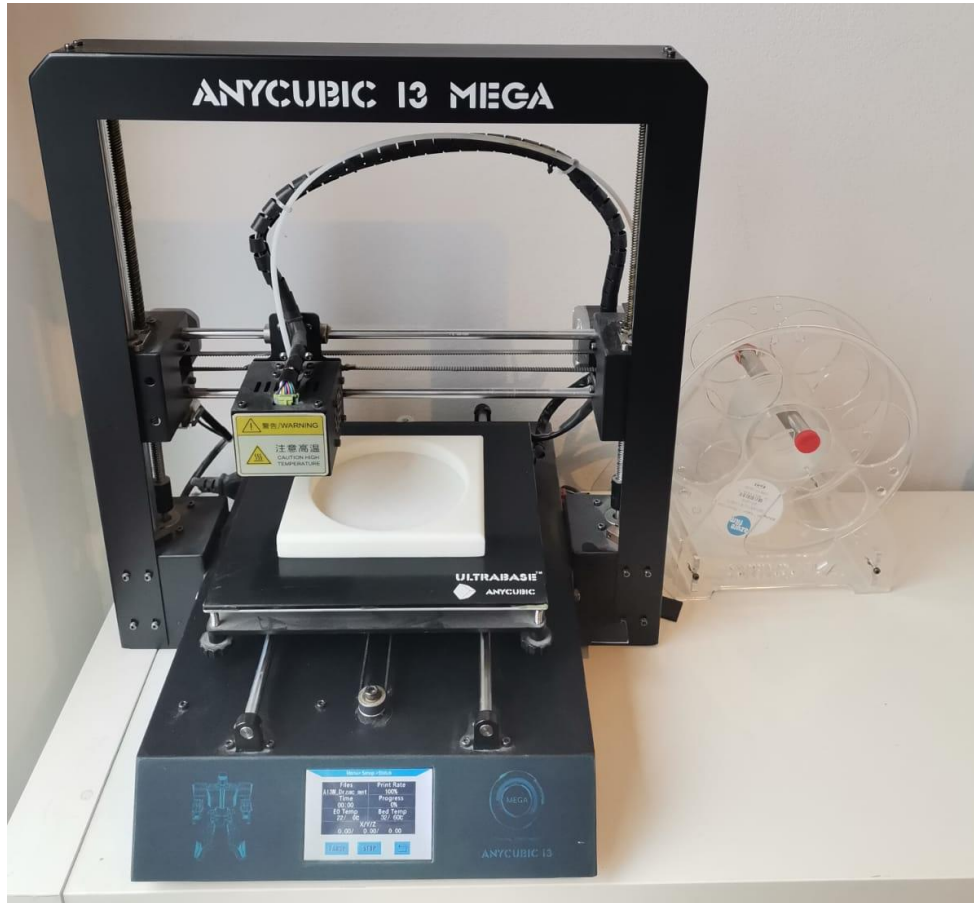
Slika 7. Izrada stražnjeg uloška za spremnik na 3D pisaču
