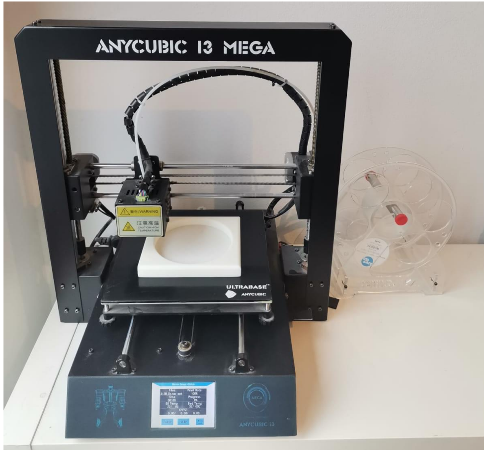
Slika 7. Izrada stražnjeg uloška za spremnik na 3D pisaču
