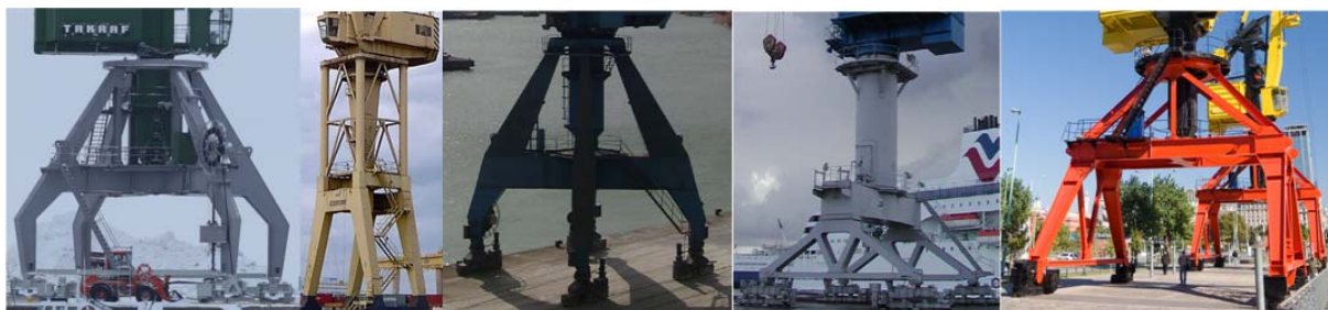
Slika 9.1 Razni oblici konstrukcije portala
