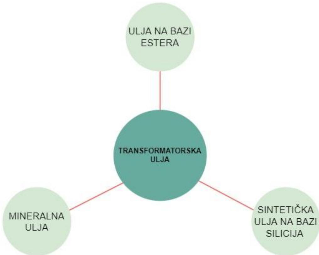
Slika 4: Prikaz podjele transformatorskih ulja prema porijeklu
