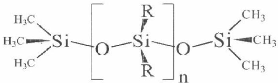
**Slika 6: Struktura sintetskih ulja na bazi silicija [21]**
