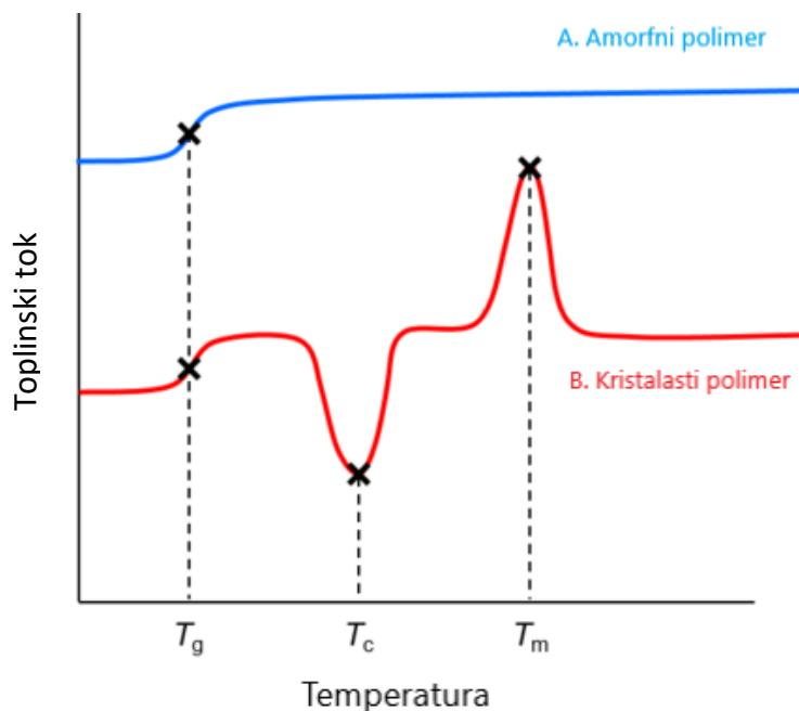
**Slika 2.3. Ovisnost pretvorbi polimera o promjeni temperature [8]**
