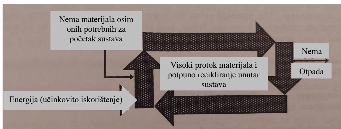
**Slika 6.1. „Closed loop“ proces (proces zatvorene petlje) [18]**
