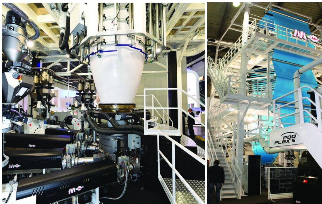
Slika 3.8. Ekstrudiranje crijevnog filma-pogon [13]
