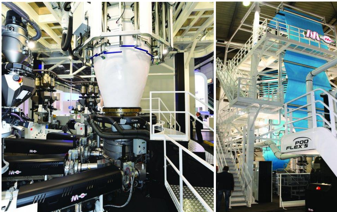
Slika 3.8. Ekstrudiranje crijevnog filma-pogon [13]
