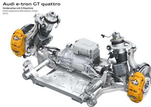
Slika 2.5. M/G stroj s poluvratilima i reduktorom te ovjes električnog vozila Audi e-tron [4].
