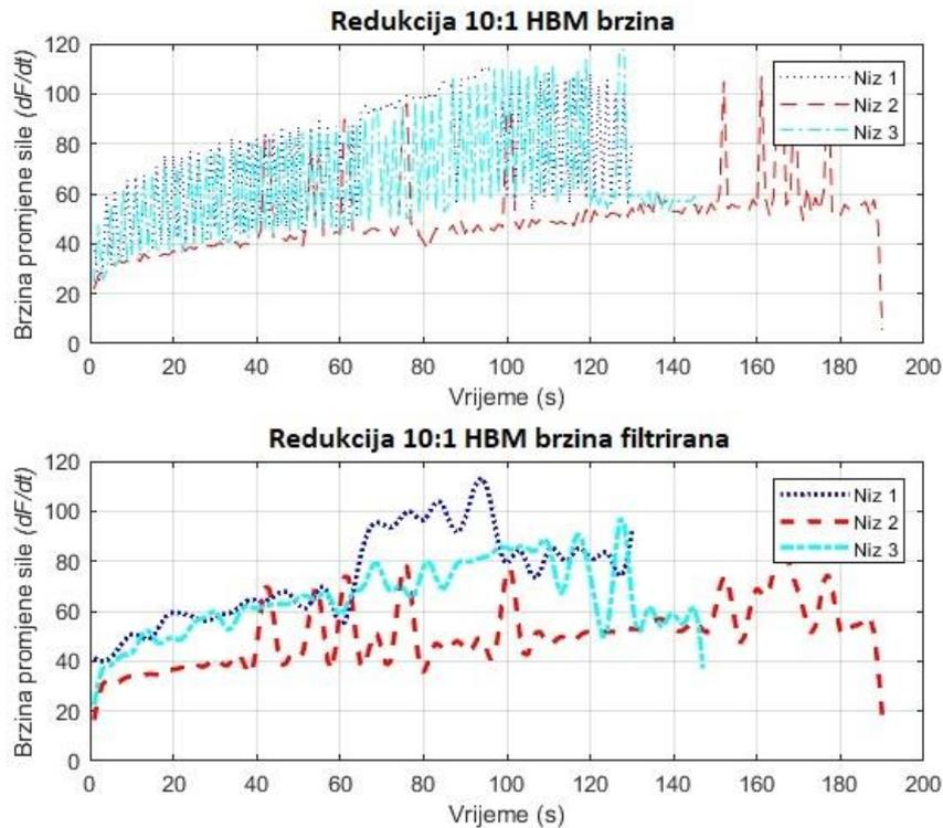
**Slika 31. Brzina prirasta sile dinamometra HBM za redukciju 10:1**
