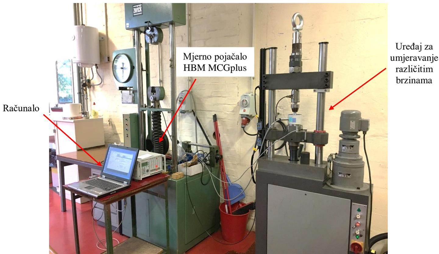
Slika 26. Kompletan sustav za provođenje umjeravanja različitim brzinama
