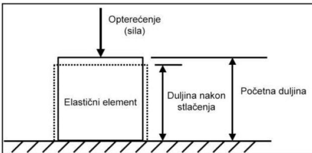
Slika 9. Dijagram elastičnog elementa pretvornika sile [1]
