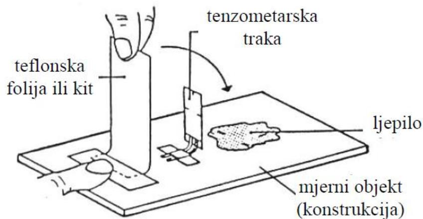
Slika 13. Lijepljenje mjerne trake na ispitni objekt [10]
