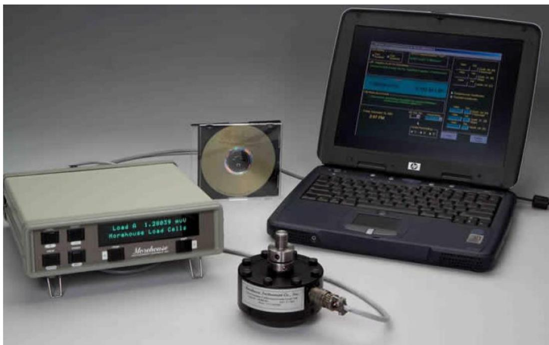
Slika 6. Prijenosni etalon sile s kompletnom opremom [6]
