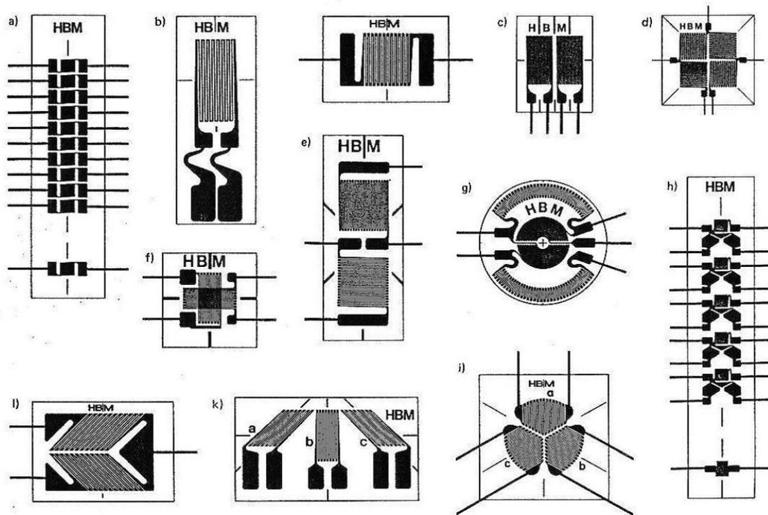
Slika 12. Različite izvedbe elektrooptičkih mjernih traka i rozeta [10]
