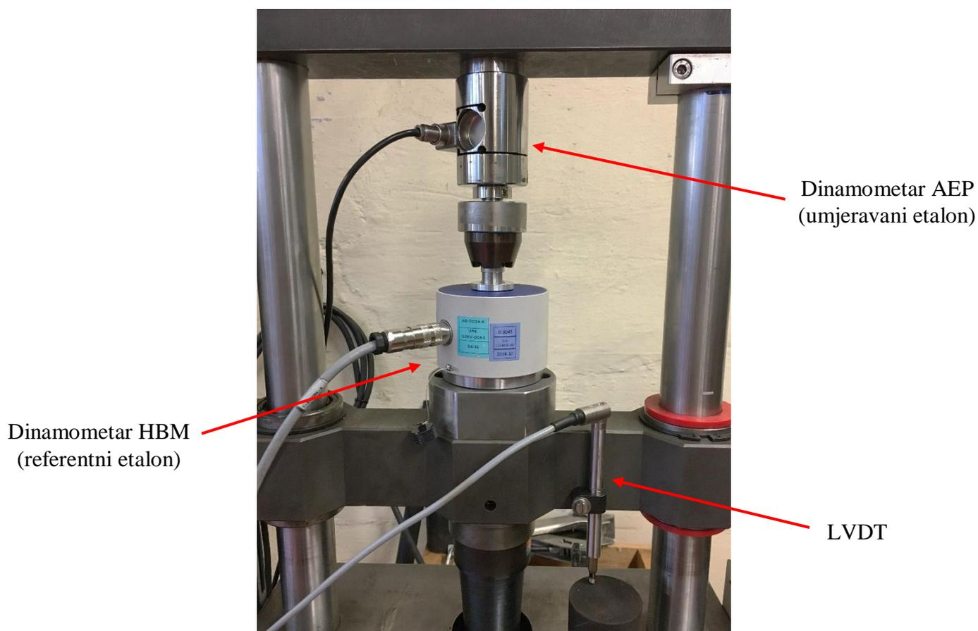
**Slika 24. Način montiranja dinamometara prilikom umjeravanja različitim brzinama**
