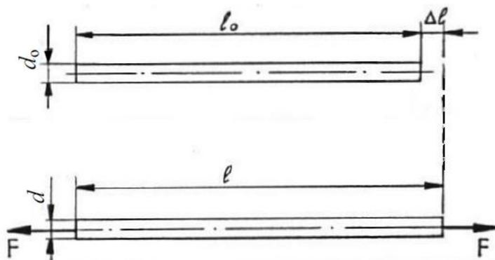
Slika 11. Deformacija žice uslijed djelovanja vlačnog opterećenja [10]
