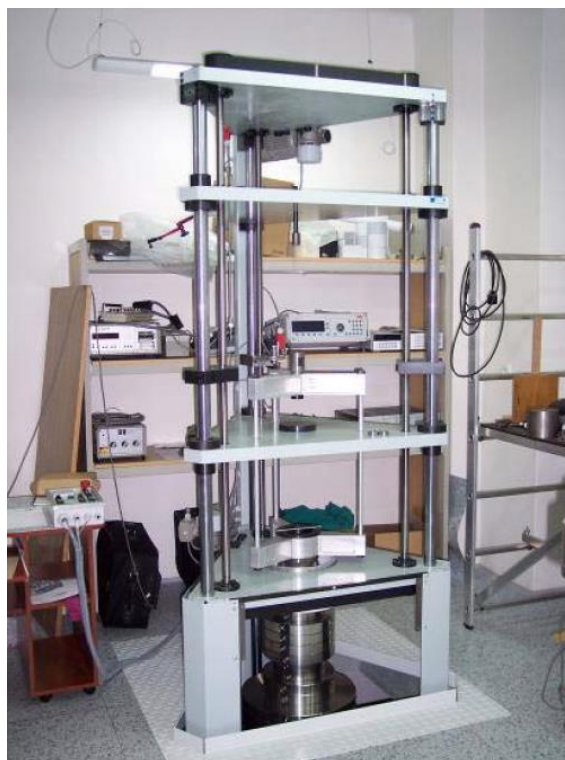
Slika 20. Nacionalni etalon ESZ 20kN [12]
