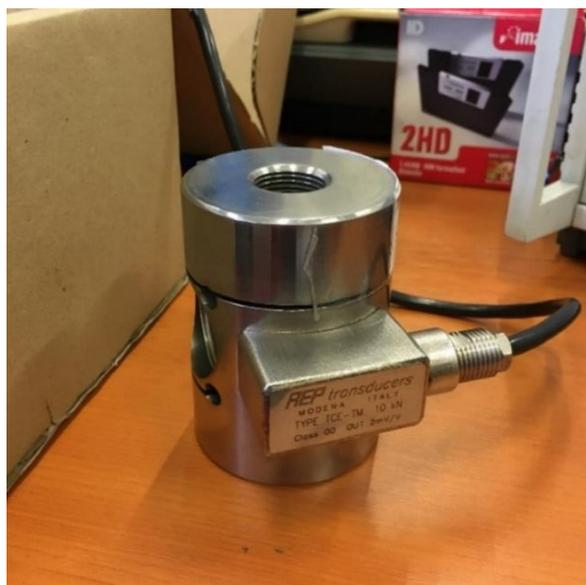
Slika 22. Dinamometar AEP TCE – TM
