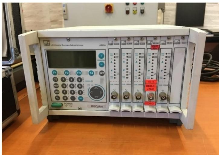
Slika 25. Mjerno pojačalo HBM MCGplus AB22A
