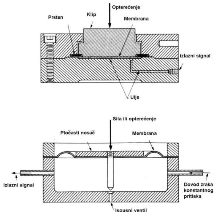
Slika 17. Presjeci hidrauličnog i pneumatskog pretvornika [9]
