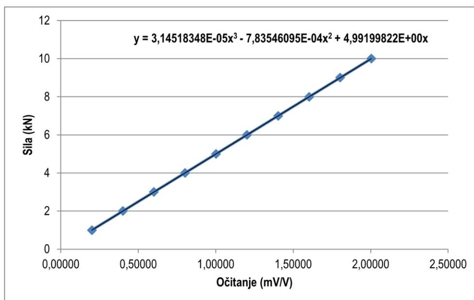
Slika 28. Inverzna krivulja interpolacije dinamometra AEP TCE – TM
