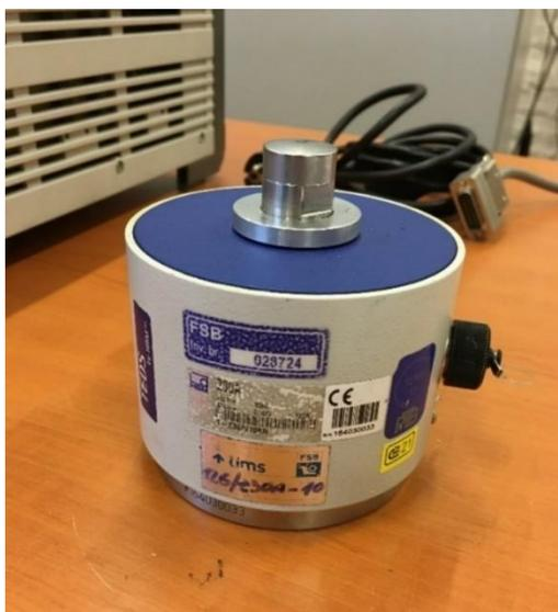
Slika 19. Dinamometar HBM Z30A 10kN
