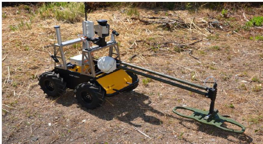
**Slika 1 Primjer mobilnog robota za detekciju mina**
