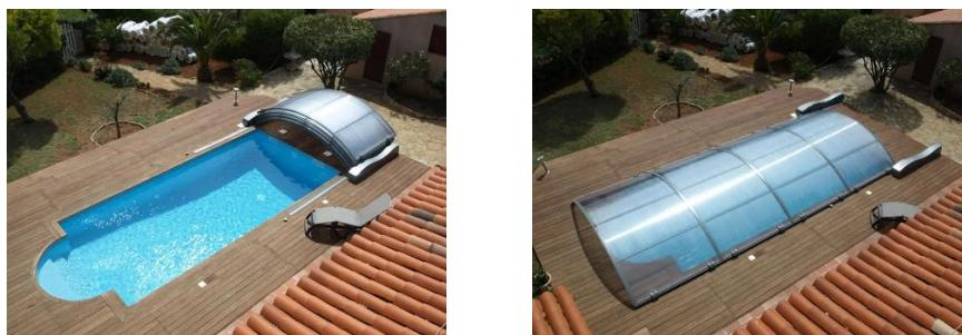
Slika 14. Abrisud niskoprofilni pomični krov: a) otvoreni položaj, b) zatvoren položaj [15]
