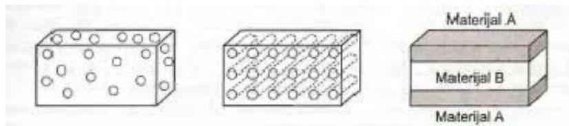
**Slika 2.1 [2] usporedba osnovnih tipova kompozita: kompoziti sa česticama, kompoziti sa vlknima, slojeviti kompoziti**
