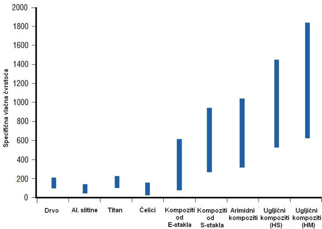
**Dijagram 2.10 [3] specifični vlačni modul različitih vrsta konstrukcijskih materijala**
