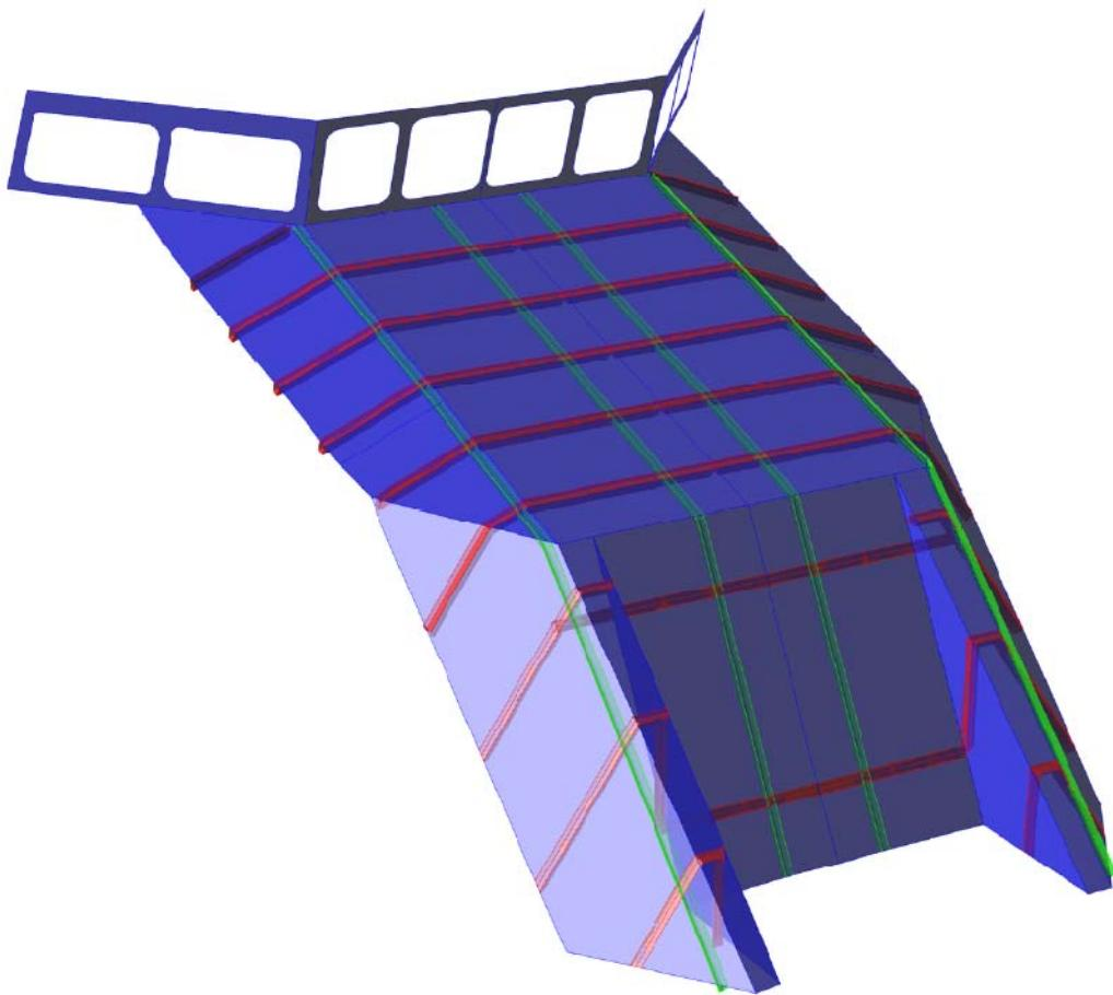
Slika 4.9 3-D model strukture krova nadgrađa
