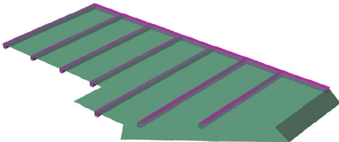
Slika 4.8 3-D model strukture krova nadgrada
