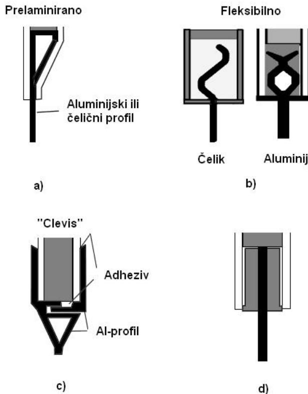
Slika 8.1 [14] Različite vrste spojeva za sendvič strukture
