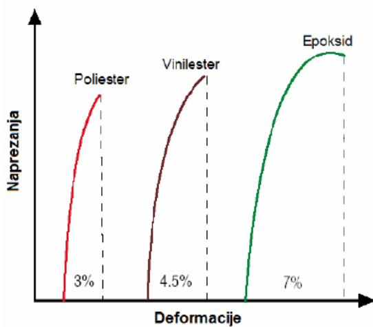
**Epoksidne smole** su najčešće upotrebljavane duromerne matrice zbog svojih dobrih mehaničkih svojstava, dobre postojanosti na agresivne medije, visoke toplinske postojanosti, lakog korištenja, a i dobro reagiraju s većinom vrsti vlakana. Glavni nedostaci jesu visoka cijena proizvodnje u odnosu na ostale vrste duromernih smola, osjetljivost na vlagu, sporo polimeriziranje, mala otpornost nekim organskim spojevima (organskim kiselinama i fenolima) te relativno niska najviša temperatura primjene.
