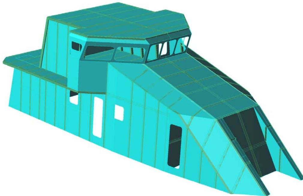
Slika 6.5 3-D model nadgrada za proračun mase i centracije
