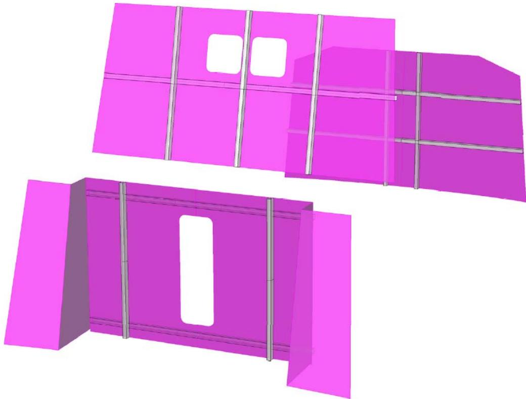
**Slika 4.10 3-D model strukture stražnjeg dijela nadgrada sa prednjom pregradom**
