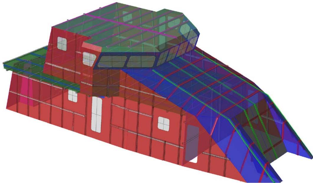
**Slika 6.2 3-D model nadgrada od stakloplastike za proračun masa i centraciju**
