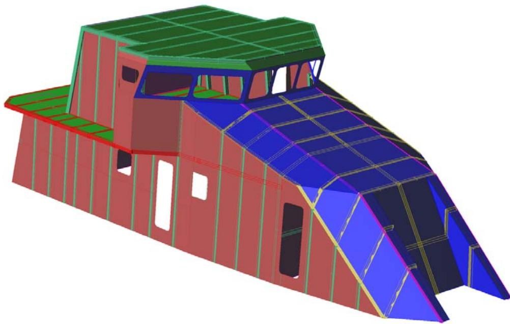
**Slika 5.5 3-D model konstrukcije nadgrađa od sendvič konstrukcije**
