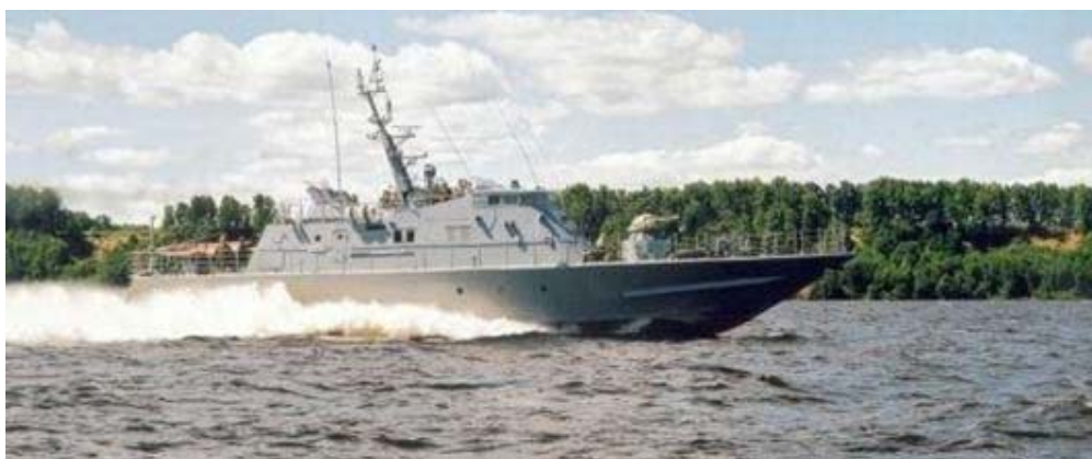
Slika 1.1 Patrolni brod sa kompozitnom protubalističkom zaštitom
