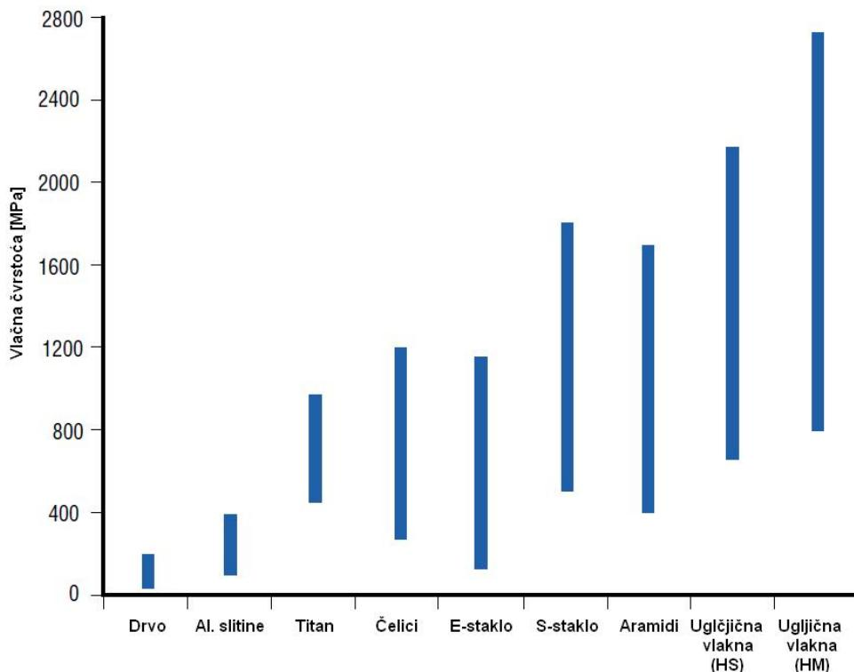
**Dijagram 2.7 [3] vlačni modul različitih vrsta konstrukcijskih materijala**
