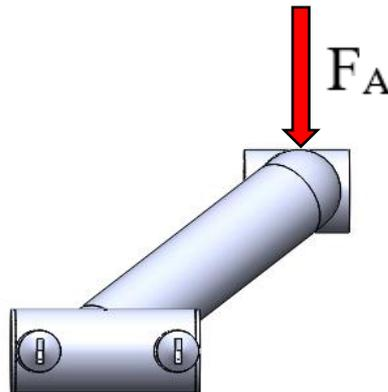
**Slika 18. Opterećenje na uvijanje**
