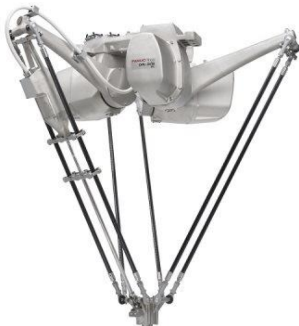
Slika 5. Fanuc DR-3iB/8L delta robot [7]
