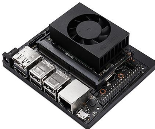
Slika 1. NVIDIA Jetson Xavier NX Developer Kit [1]
