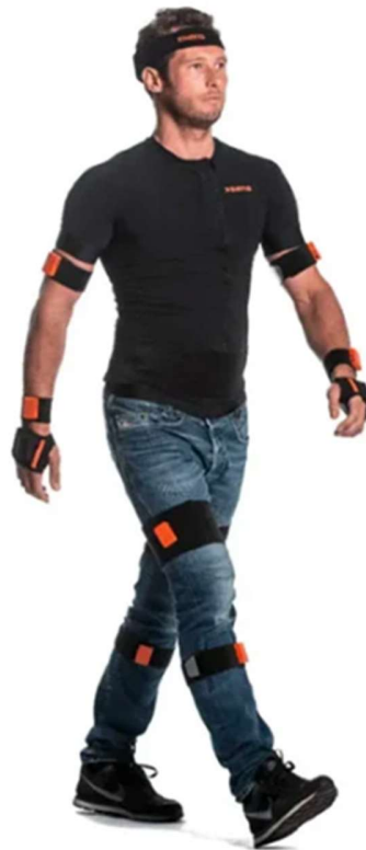
Slika 13. Senzori za mjerenja pokreta postavljeni na osobu [17]
