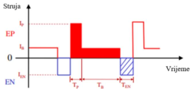
Slika 24: Valni oblik struje za AC MIG [20]
