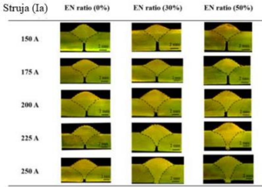
Slika 26: Ponašanje geometrije zavara u ovisnosti o jakosti struje i EN omjeru [23]
