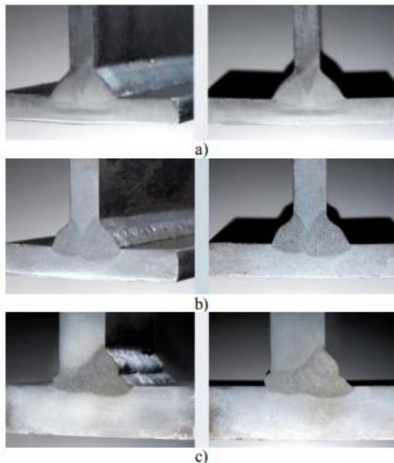
**Slika 14: Prikaz kutnog spoja izvedenog RMT postupkom (materijal- ST 37) : a)  $d=6\text{mm}$ ; b)  $d=8\text{mm}$ ; c)  $d=20\text{mm}$  [9]**
