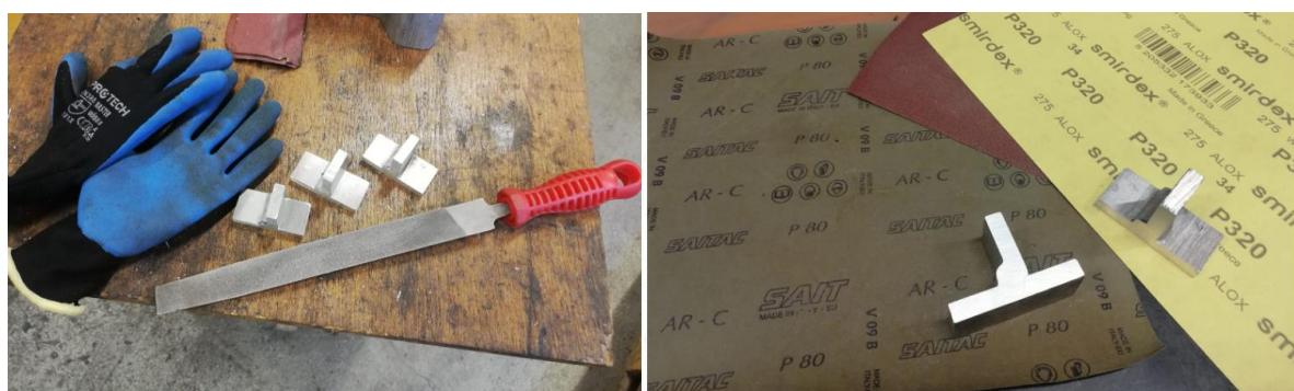
Slika 46: Skidanje oštih rubova i brušenje uzorka
