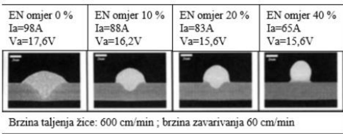
Slika 25: Utjecaj balansa na geometriju zavara [22]
