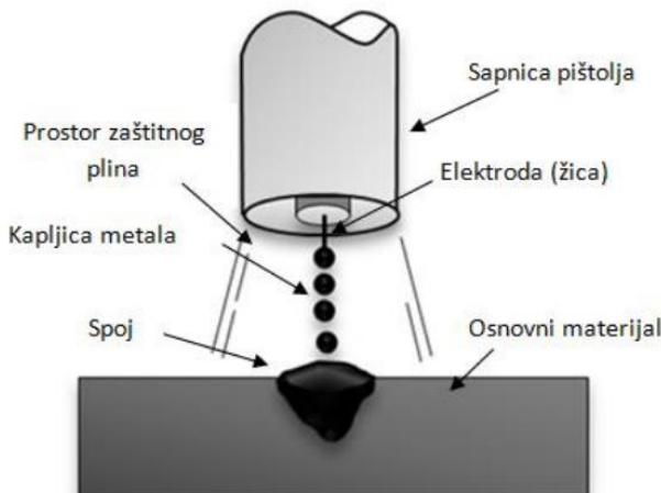
**Slika 7: Shematski prikaz prijenosa metala štrcajućim lukom [6]**
