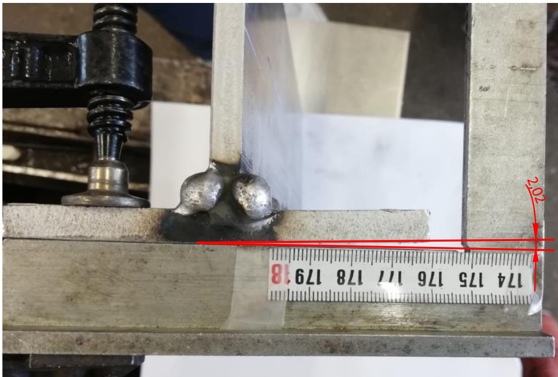
Slika 59: Kutna deformacija zavarenog spoja
