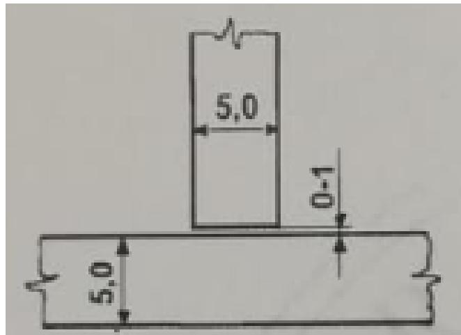
Slika 32: Priprema prije zavarivanja i debljine ploče
