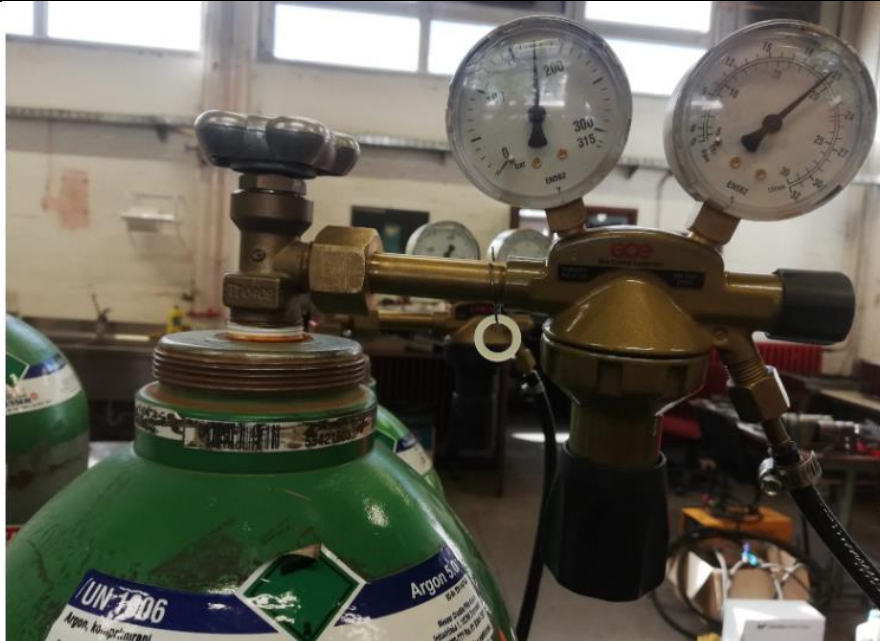
Slika 38: Manometar sa zadanim protokom zaštitnog plina
