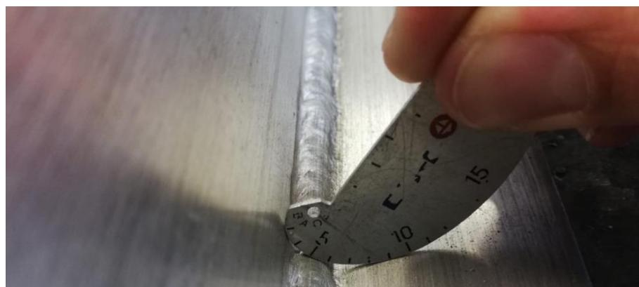
**Slika 57: Mjerenje visine šava zavara**
