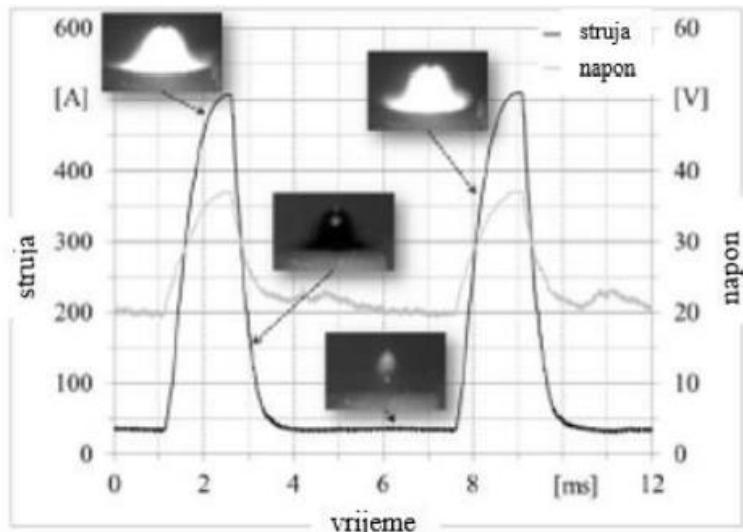
Slika 22: Prikaz karakteristike struje i napona za DC MIG postupak [18]
