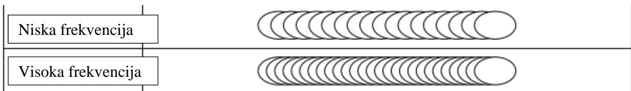
**Slika 31:** Izgled zavara pri niskim i visokim iznosima frekvencije [26]
