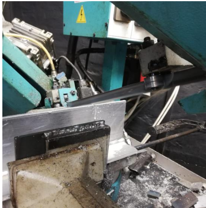
Slika 45: Rezanje uzoraka na pili BS 350 GH
