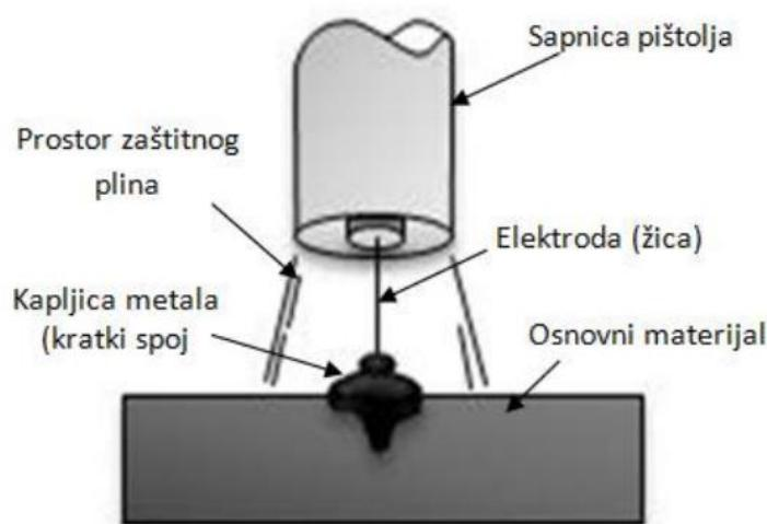
Slika 5: Shematski prikaz prijenosa metala kratkim spojem [6]
