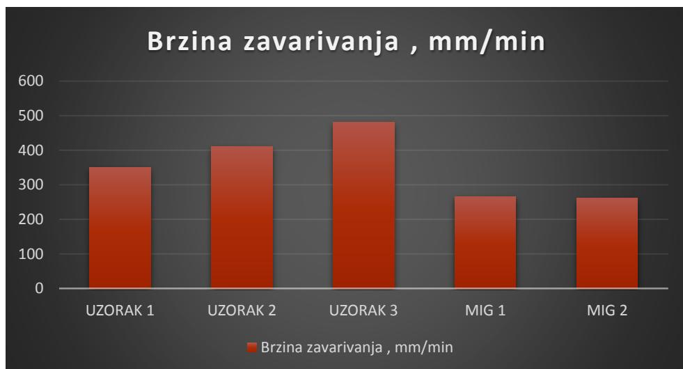
Slika 44: Usporedba brzina zavarivanja uzoraka i postojeće tehnologije
