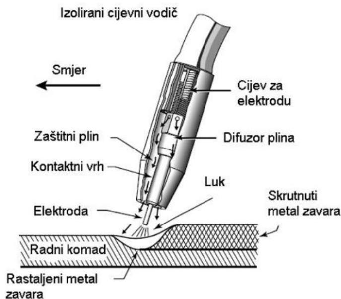
Slika 4: Dijelovi sapnice pištolja za MIG zavarivanje [4]
