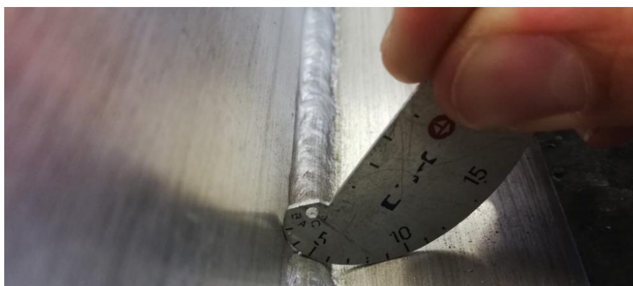
Slika 57: Mjerenje visine šava zavara
