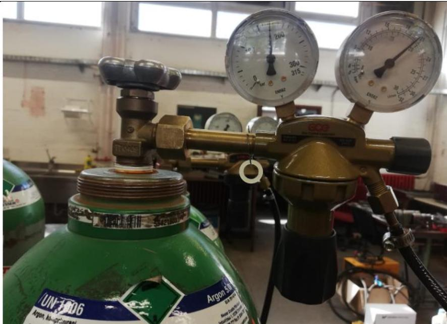
Slika 38: Manometar sa zadanim protokom zaštitnog plina
