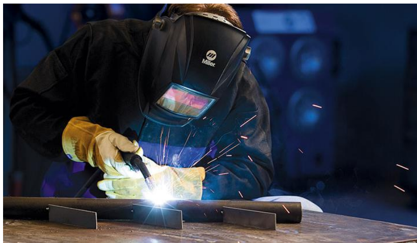
Slika 1: Postupak MIG zavarivanja [3]
