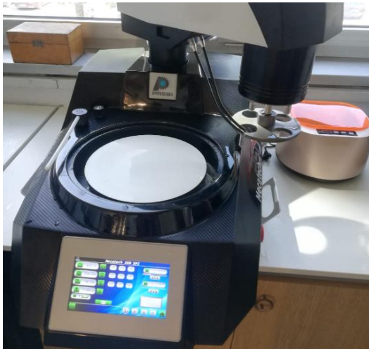
Slika 47: Stroj za brušenje makrouzoraka Mecatech 250 SPI
