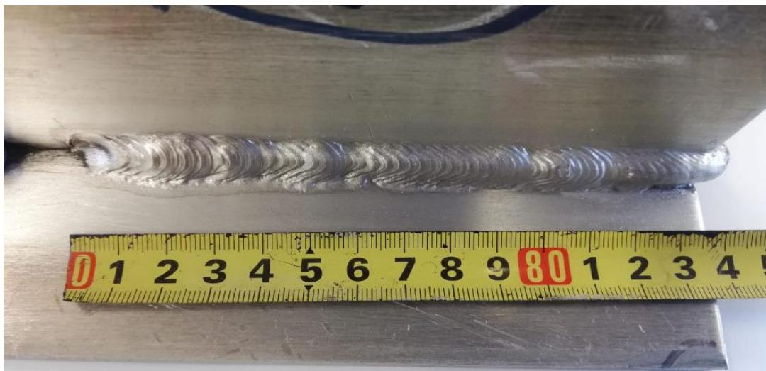
**Slika 40: Uzorak 1 (Balans postavljen na 0)**
