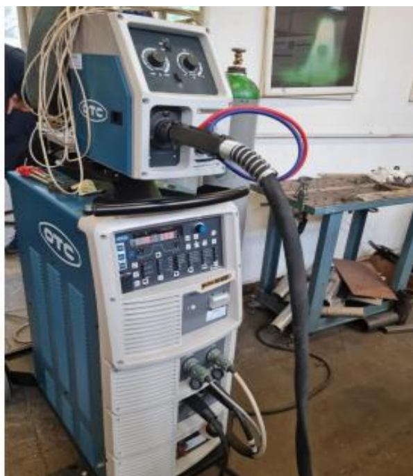
Slika 36: Uređaj za zavarivanje Welbee Inverter W400
