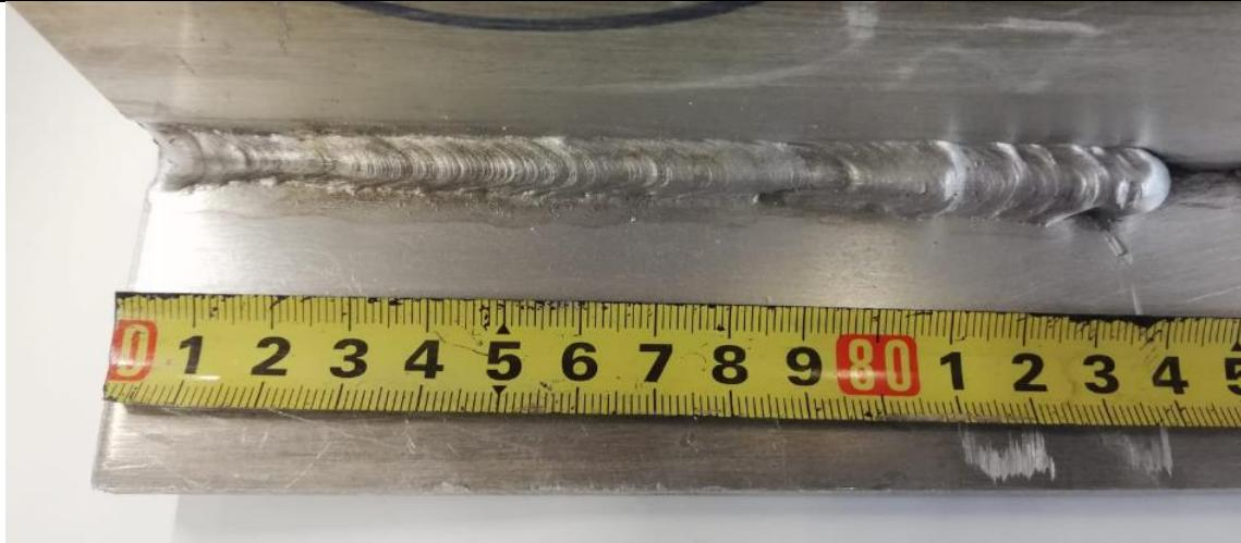
Slika 41: Uzorak 2 (Balans postavljen na -30)
