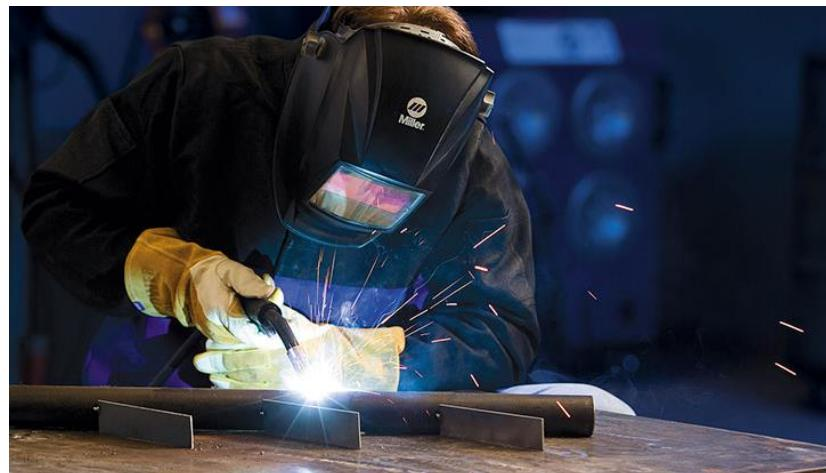
Slika 1: Postupak MIG zavarivanja [3]
