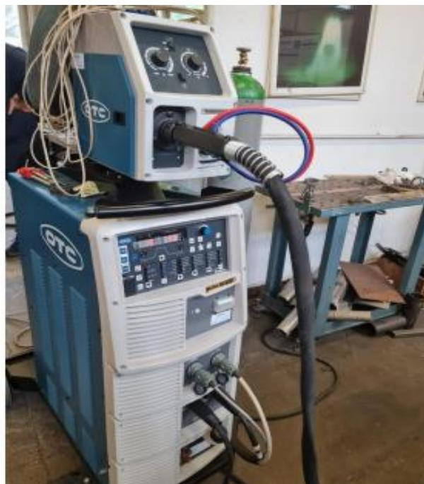
Slika 36: Uredaj za zavarivanje Welbee Inverter W400
