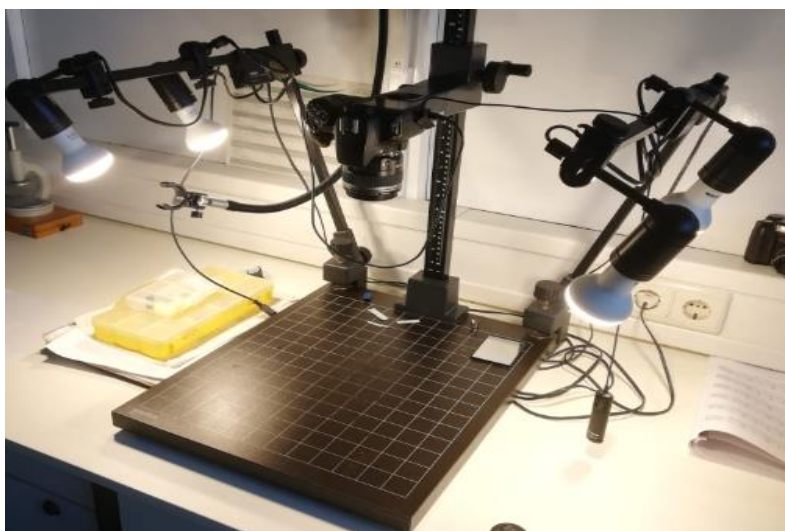
Slika 49: Postolje za slikanje makrostrukture
