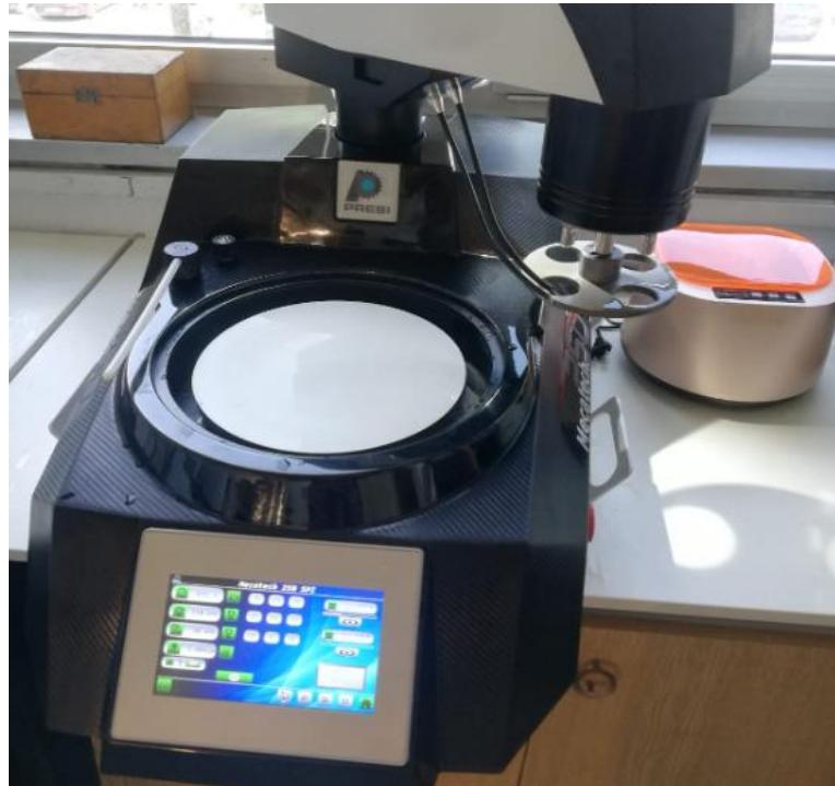
**Slika 47:** Stroj za brušenje makrouzoraka Mecatech 250 SPI
