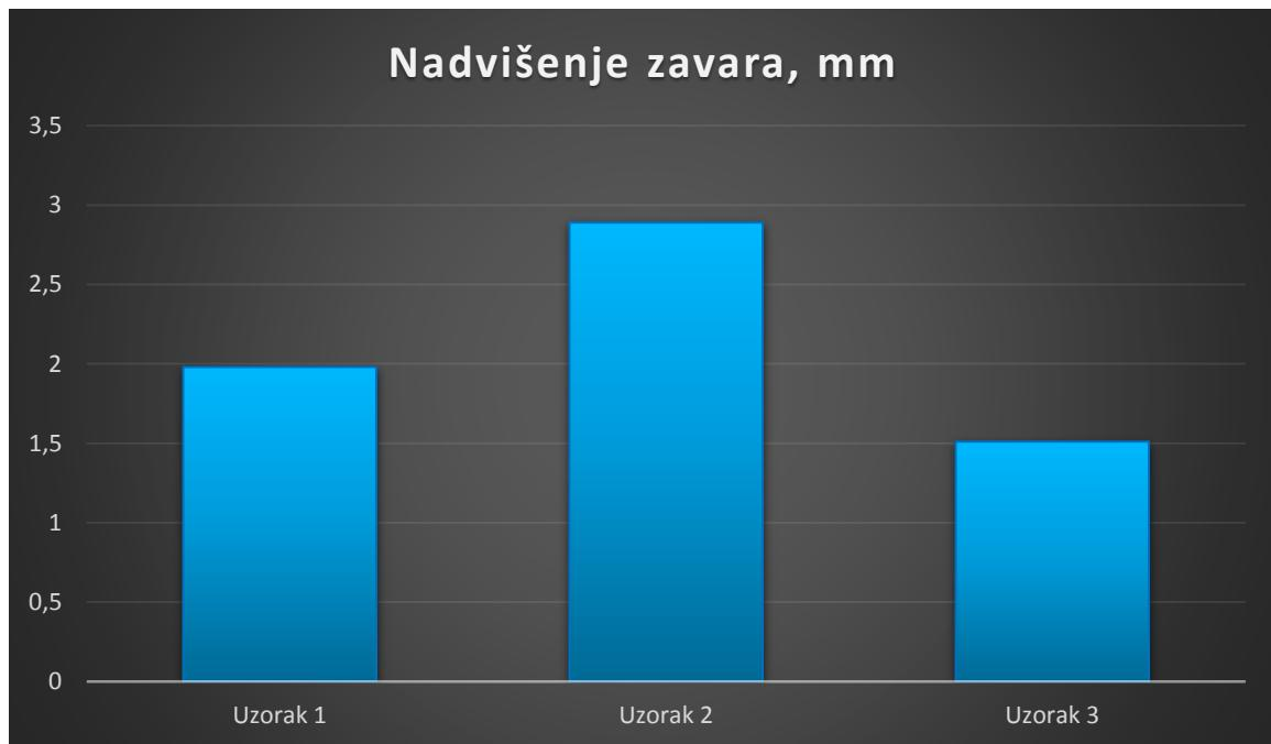
Slika 55: Histogramski prikaz nadvišenja zavara uzoraka
