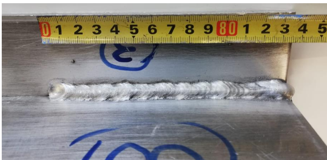
Slika 42: Uzorak 3 (Balans postavljen na +30)
