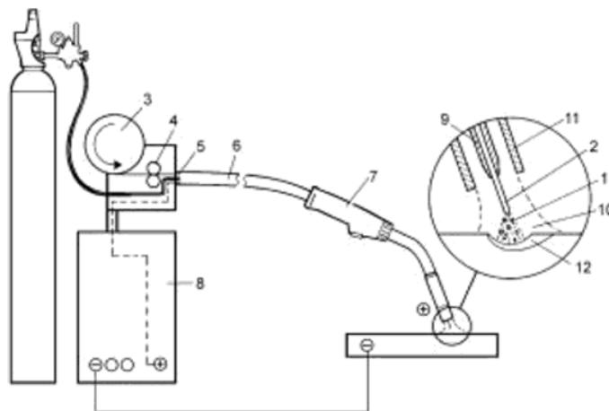
Slika 3: Shema opreme za MIG zavarivanje [1]
