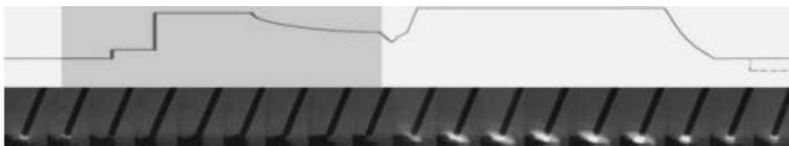
Slika 13: Krivulja jakosti struje FastRoot postupka za jedan ciklus [9]
