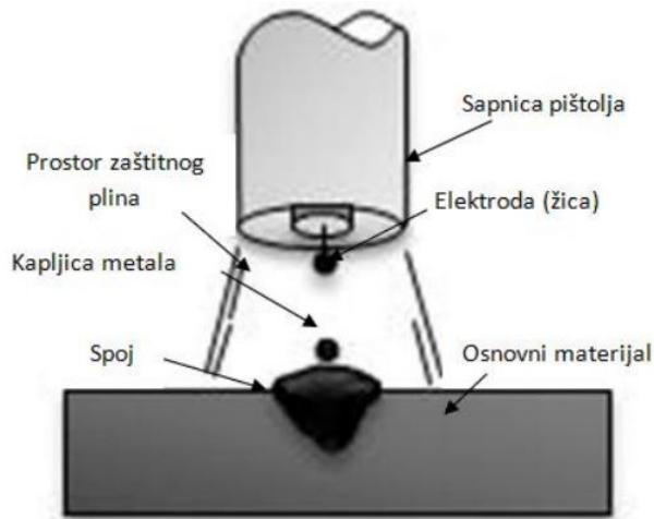
**Slika 9:** Shematski prikaz metala pulsirajućim lukom [6]
