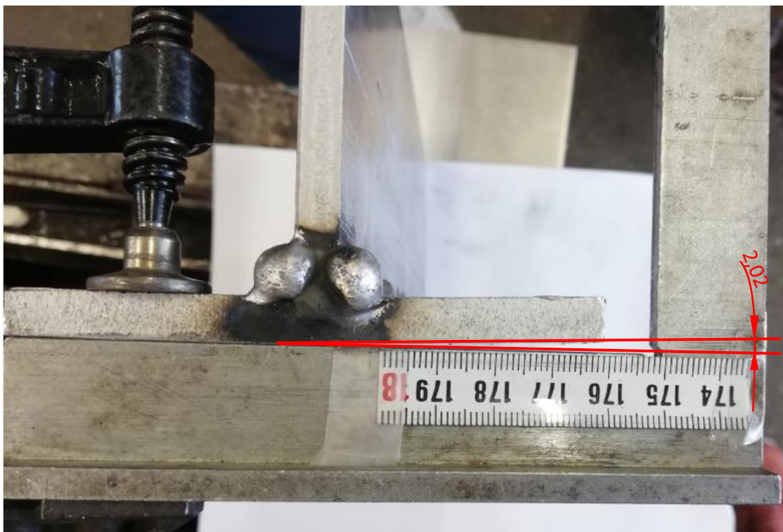
Slika 59: Kutna deformacija zavarenog spoja
