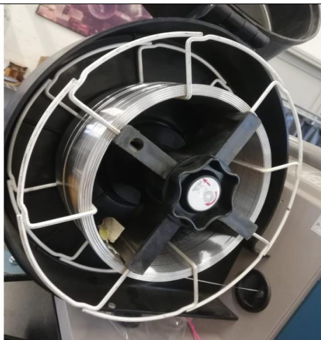
Slika 37: Namotaji žice na uređaju, AlMg5
