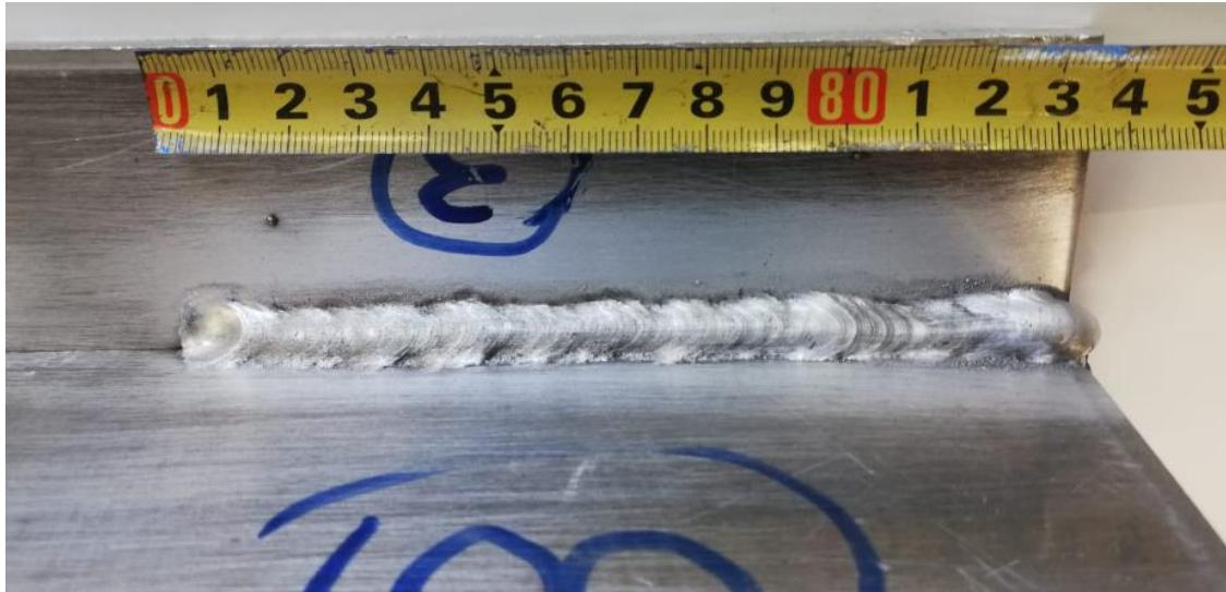
Slika 42: Uzorak 3 (Balans postavljen na +30)
