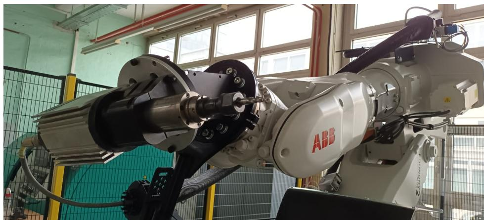
**Slika 17. Montirane prirubnice s motorvretenom na robotsku ruku**
