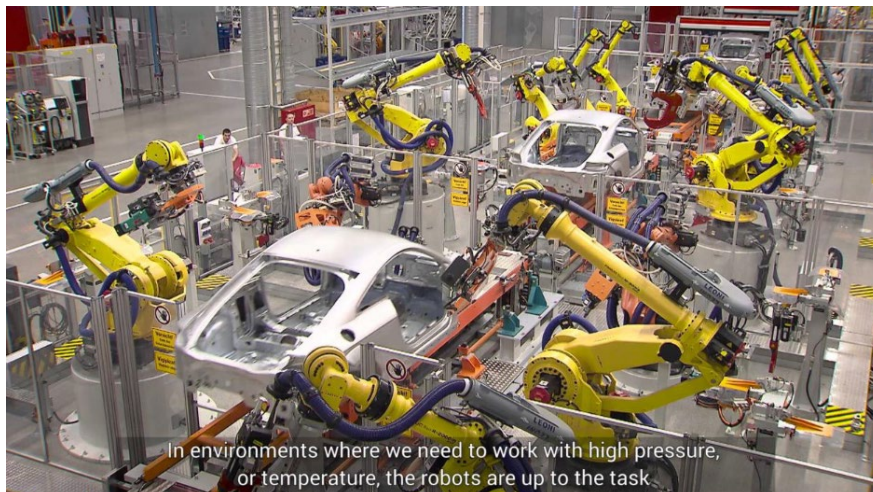
Slika 5. Roboti za zavarivanje u autoindustriji [7]
