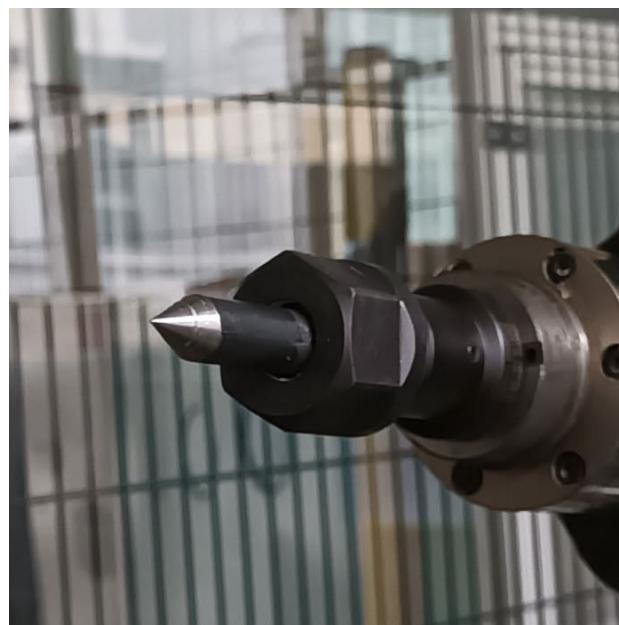
**Slika 19. Šiljak stegnut u steznu čeljust motorvretena**
