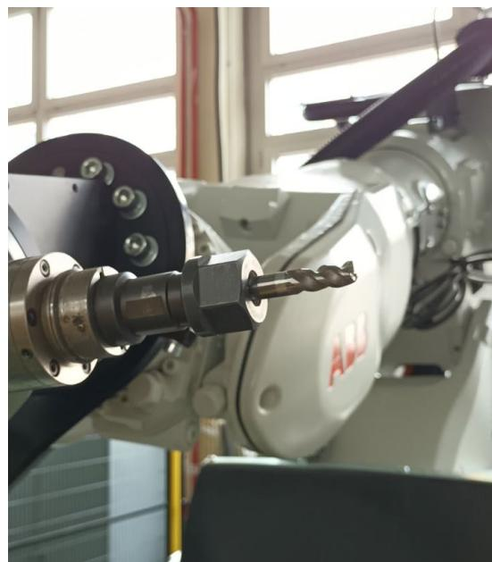
**Slika 26. Glodalo stegnuto u steznu čahuru motorvretena**
