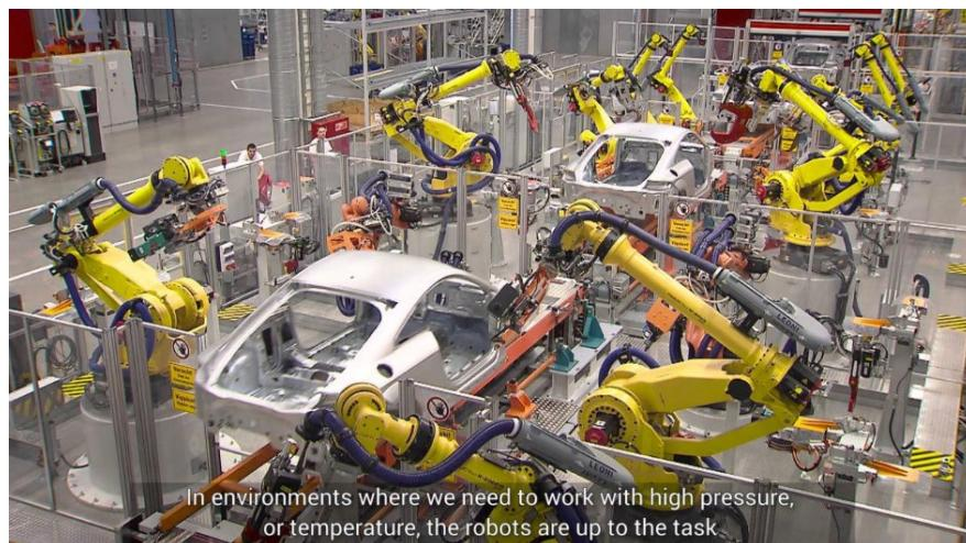
**Slika 5. Roboti za zavarivanje u autoindustriji [7]**
