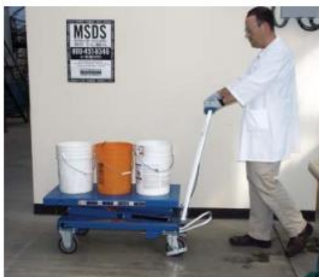
Slika 13. Kolica s kočnicom i mogućnošću podizanja tereta
