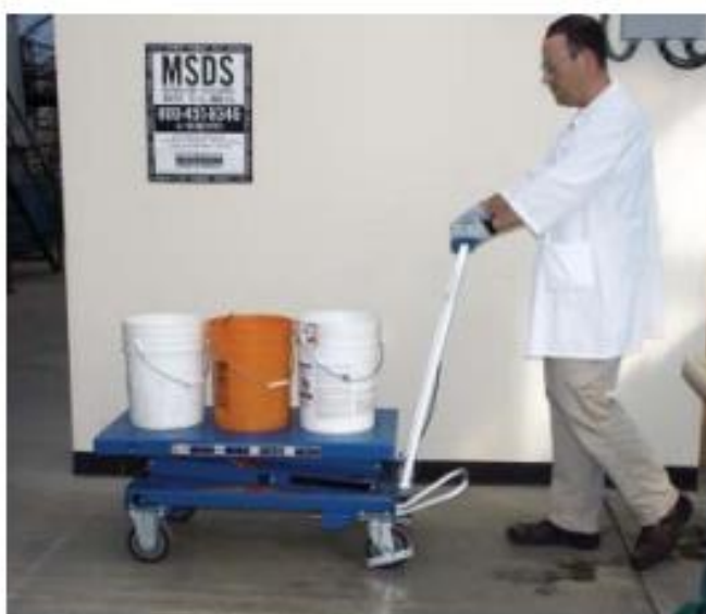
Slika 13. Kolica s kočnicom i mogućnošću podizanja tereta
