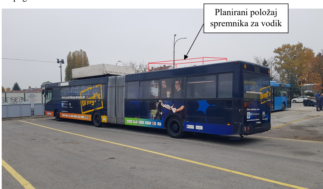
Slika 25. Planirani položaj spremnika vodika
