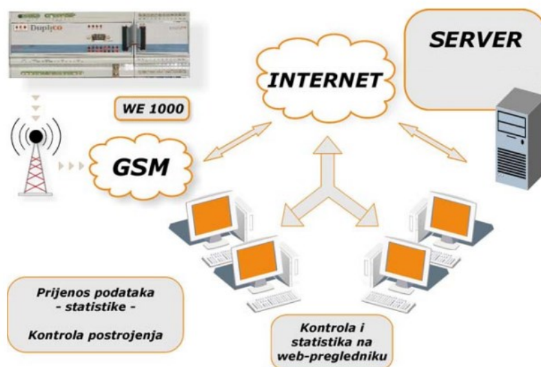
Slika 29. Vođenje statistike i pregled stanja sustava za odorizaciju [22]
