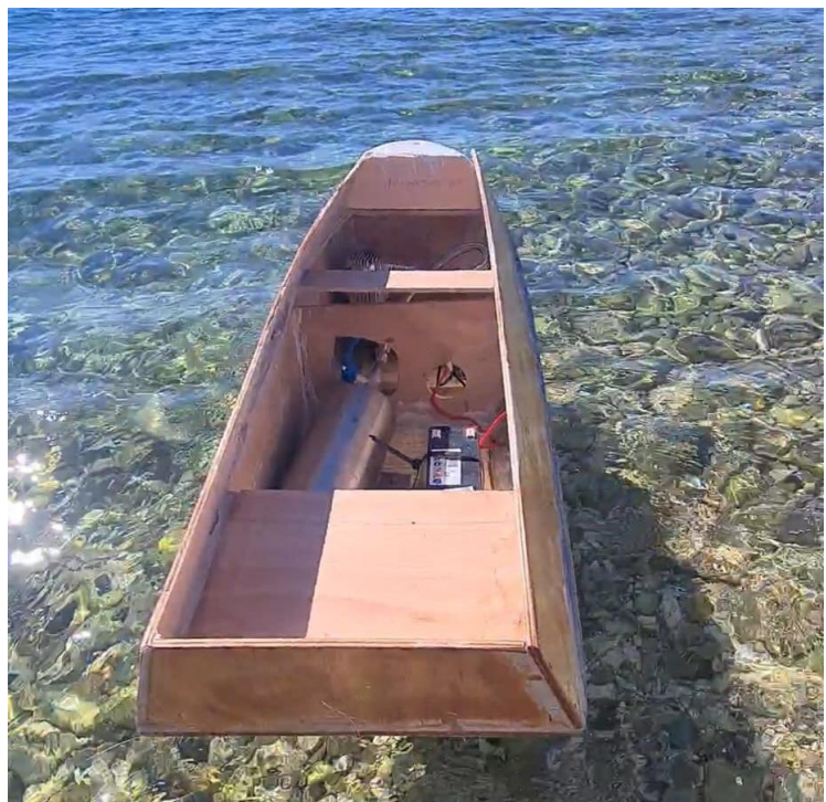
Slika 5.7. Konačan izgled sustava prilikom testiranja
