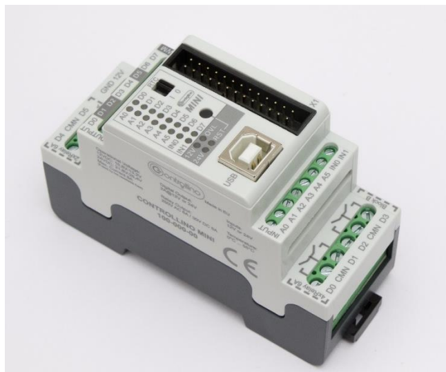
Slika 5.1. Upravljački uređaj Controllino Mini
