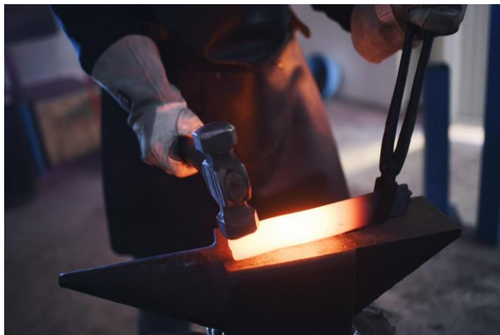
Slika 1. Slobodno kovanje u kovačnici [1]
