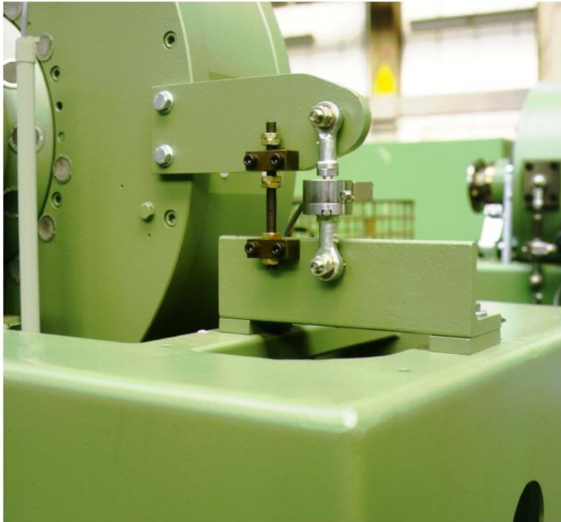
Slika 1: Primjer mjerenja reakcijskog momenta [1]
