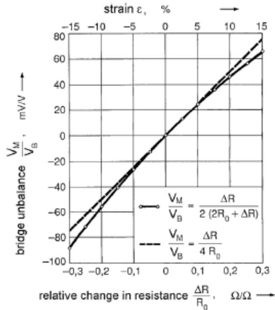
**Slika 7:** Nelinearna karakteristika Wheatstone-ovog mosta uz promjenu jednom otporu [2]
