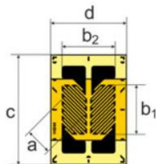
Slika 12: Rozeta za mjerjenje tangencijalnih naprezanja HBK [5]
