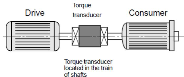
Slika 2. Shema postavljanja pretvornika u sustav [1]
