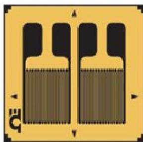
**Slika 15:** Udvojeni paralelni tenzometar [3]
