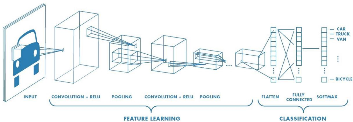
Slika 2.8. CNN sekvenca za klasifikaciju vozila (eng.) [7]
