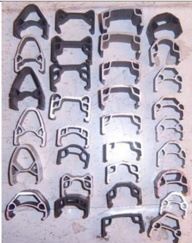
Slika 40. Različiti profili za obruč kotača [21]
