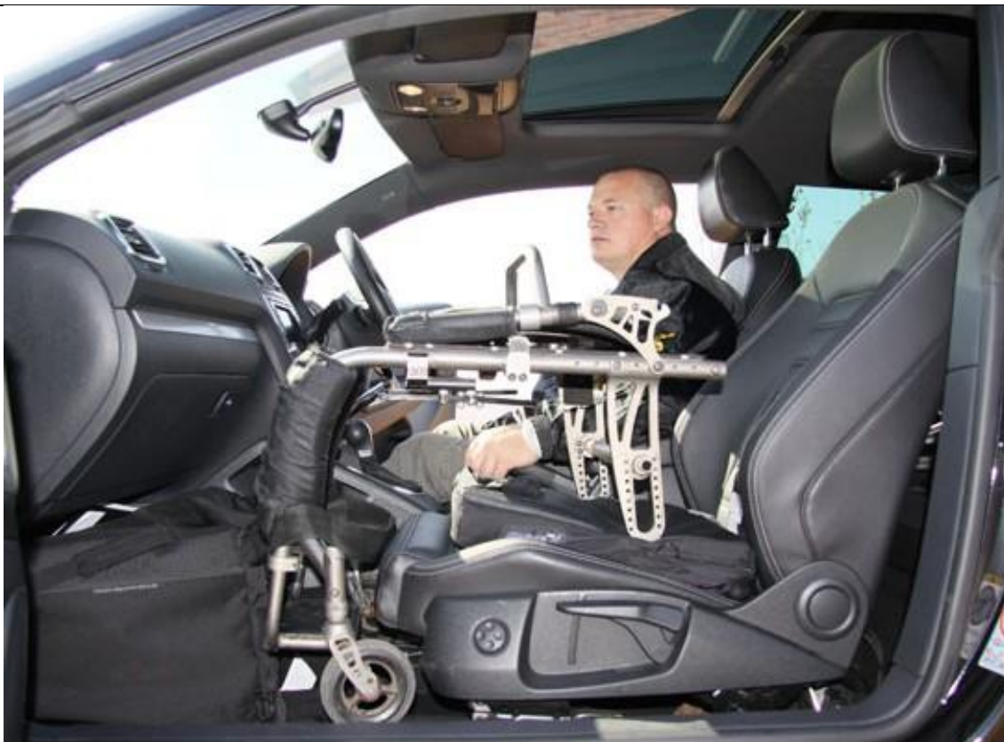
Slika 11. Smještanje okvira na prednje sjedalo [5]
