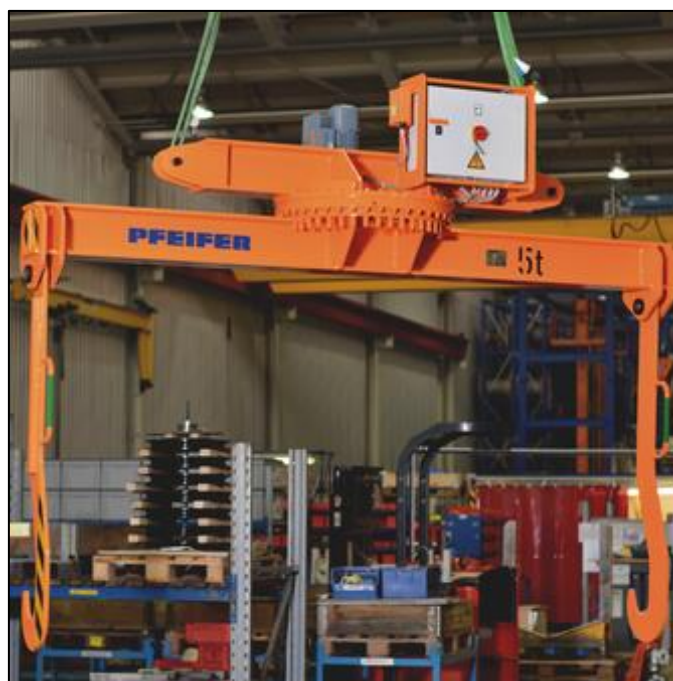
Slika 4. Rotirajući sustav pomoću zakretnog ležaja tvrtke Pfeifer [6]
