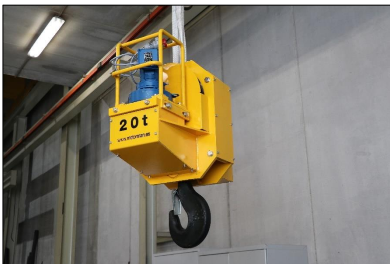
Slika 3. Sklop kuke s motoriziranom rotacijom tvrtke Motorman S.A. [5]
