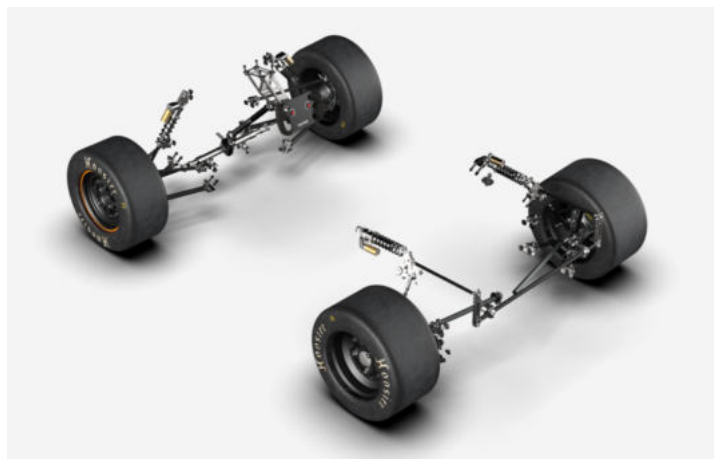
Slika 2.1. Prikaz prednjeg i stražnjeg ovjesa sa sustavom upravljanja [2]
