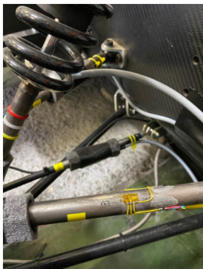
Slika 4.20. Mjerna mjesta postavljena na bolid 1
