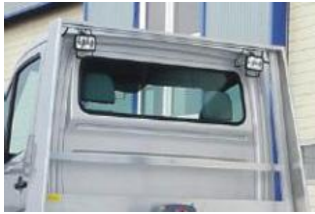
Slika 12. Radna svjetla na transportnom vozilu [9]
