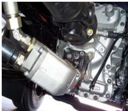
Slika 11. Hidraulička pumpa priključena na PTO spojkku [20]
