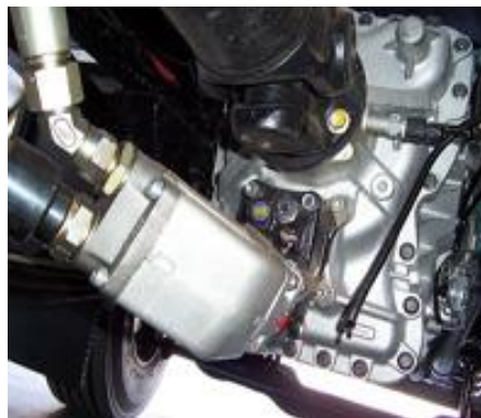
Slika 11. Hidraulička pumpa priključena na PTO spojkku [20]
