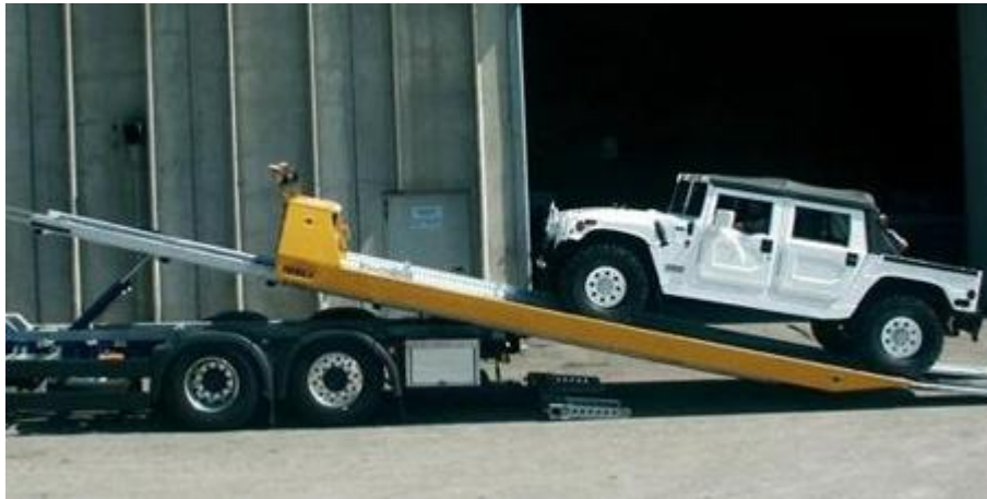
Slika 6. Pomična platforma za prijevoz vozila [8]
