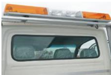
Slika 13. Rotacijska svjetla na transportnom vozilu [9]
