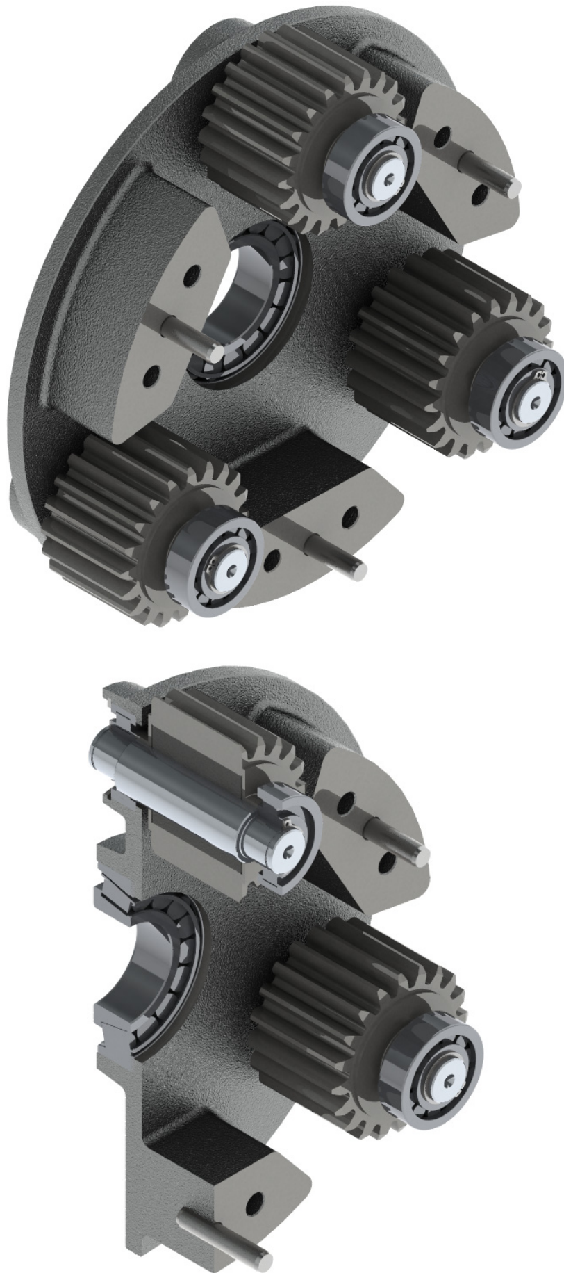
Slika 29. Podsklop manjeg dijela nosača gore te presjek dolje
