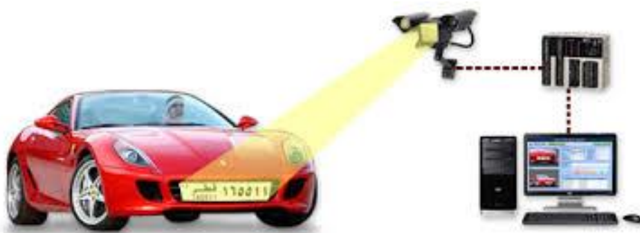
Slika 2 . Shematski prikaz rada ANPR-a
