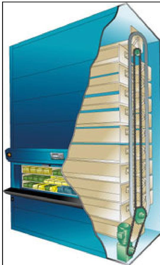
Slika 8. Vertikalni karusel
