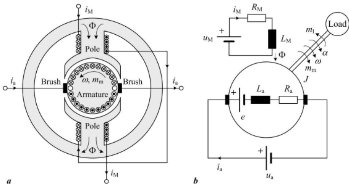
Slika 15. Shematski prikaz istosmjernog kolektorskog motora [3]
