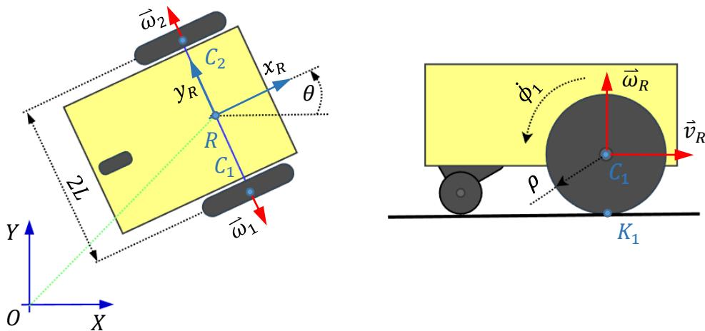
Slika 41. Kinematičke značajke robota s diferencijalnim pogonom
