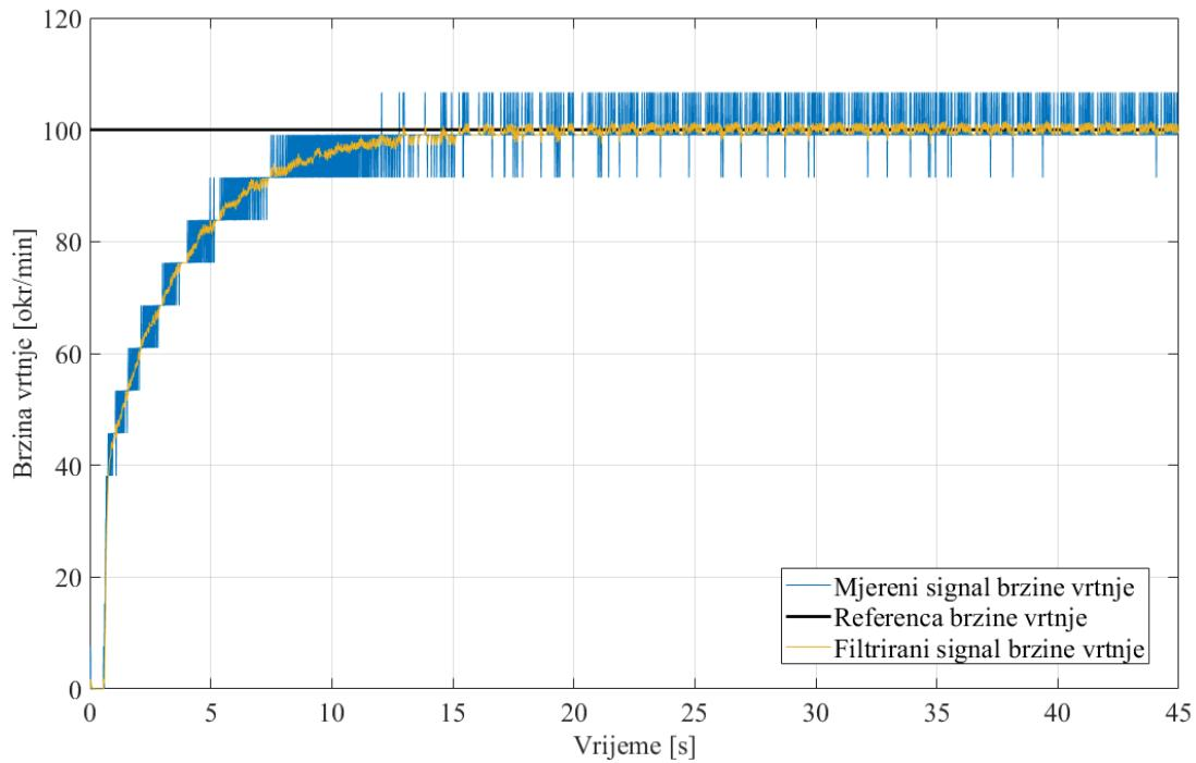
**Slika 39. Filtrirani signal mjerene brzine**
