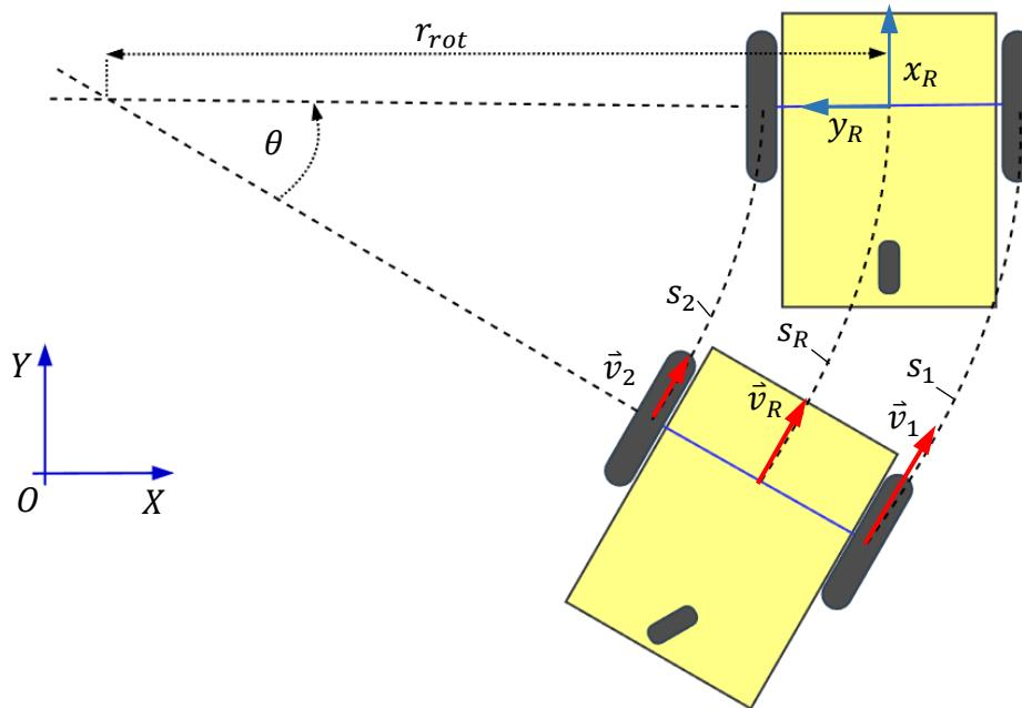
Slika 42. Kretanje diferencijalnog robota po kružnom luku
