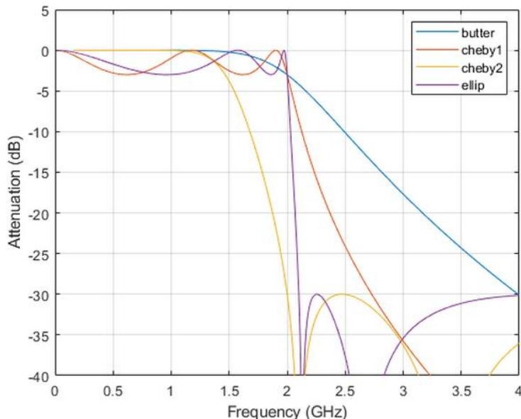
Slika 36. Prikaz različitih tipova digitalnih filtera [18]
