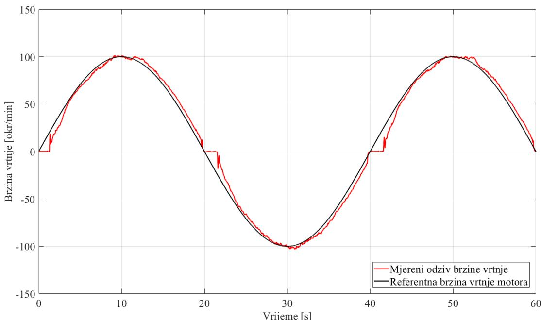
**Slika 60. Odziv brzine vrtnje elektromotora na sinusnu pobudu**
