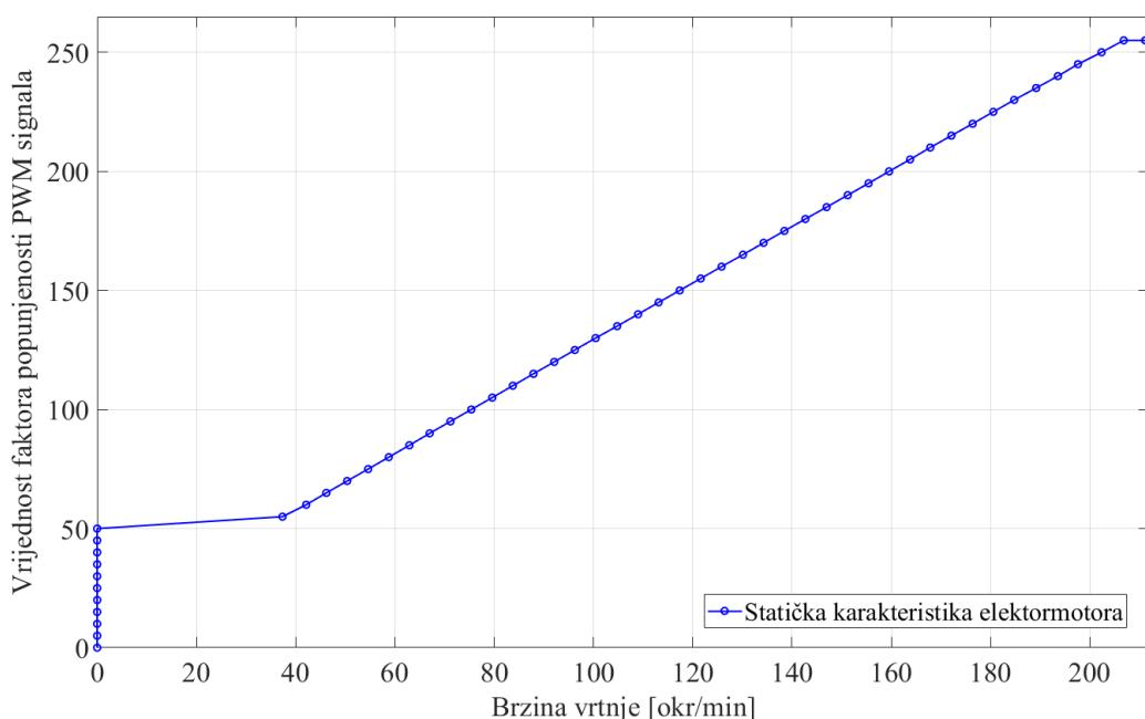
Slika 21. Statička karakteristika elektromotora Pololu 4845
