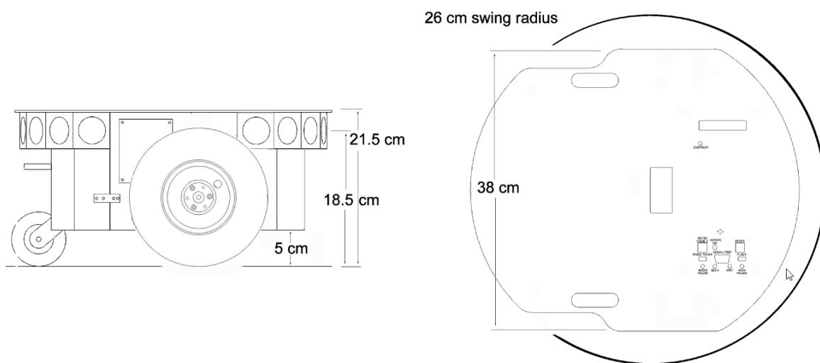
**Slika 3. Vanjske dimenzije robota Pioneer 2DX [8]**
