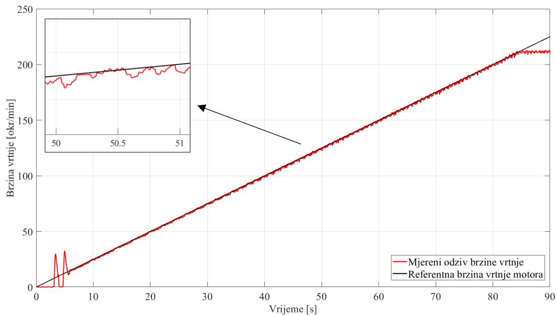
**Slika 55. Odziv brzine vrtnje elektromotora na nagibnu pobudu**
