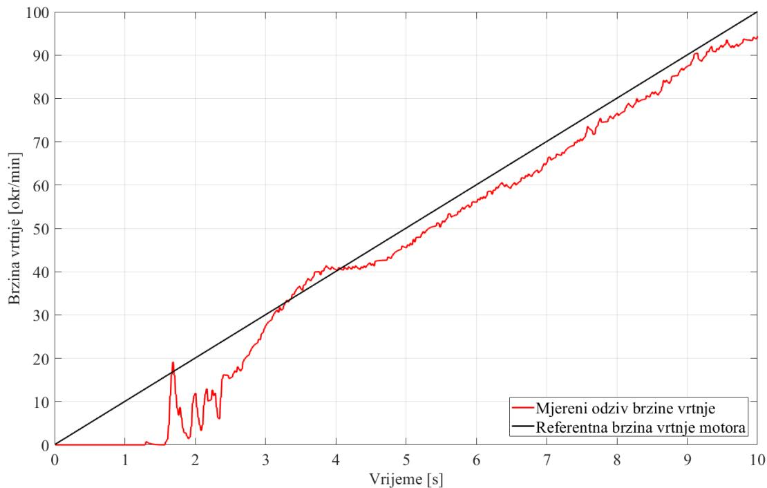
**Slika 59. Odziv brzine vrtnje elektromotora na nagibnu pobudu**
