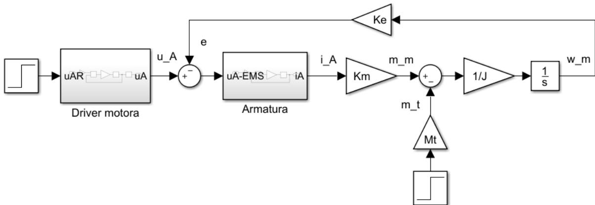
Slika 16. Dinamički model istosmjernog motora
