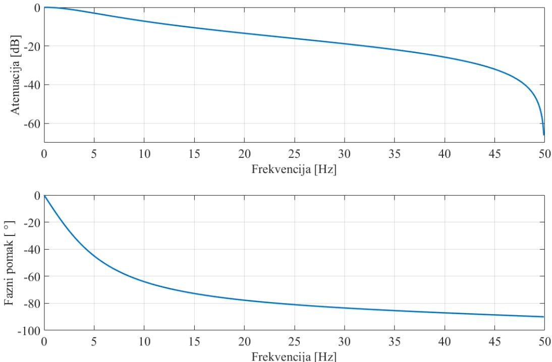
**Slika 38. Amplitudno-frekvencijska i fazno-frekvencijska karakteristika filtra**
