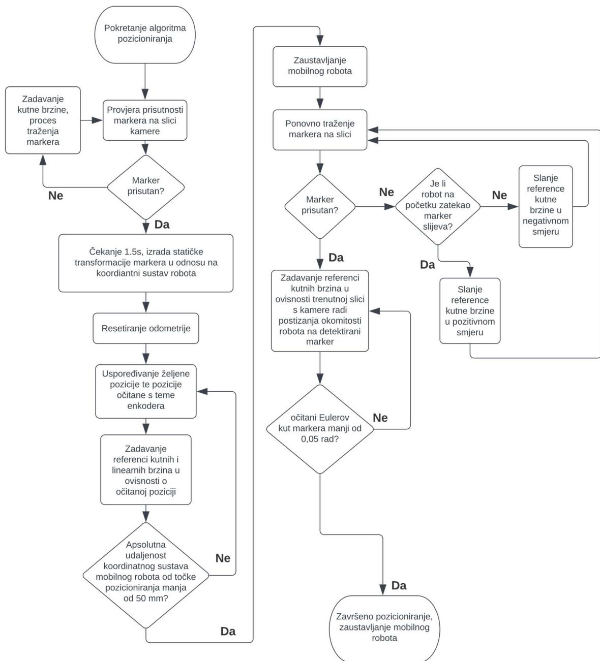
Slika 45. Dijagram toka algoritma pozicioniranja
