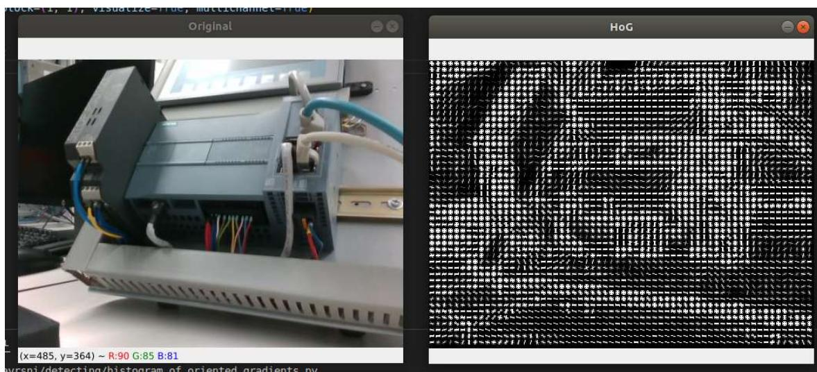
Slika 14. Primjer određivanja područja značajki sa slike primjenom *HoG* algoritma
