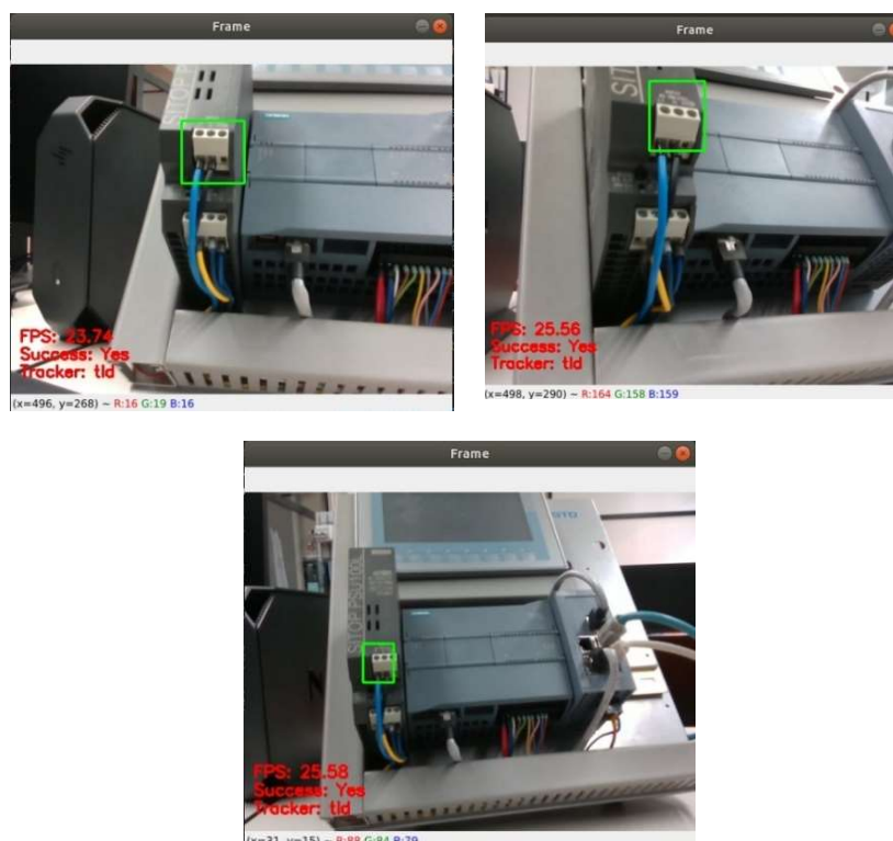
Slika 21. Praćenje rednih stezaljki PLC-a pomoću TLD algoritma praćenja
