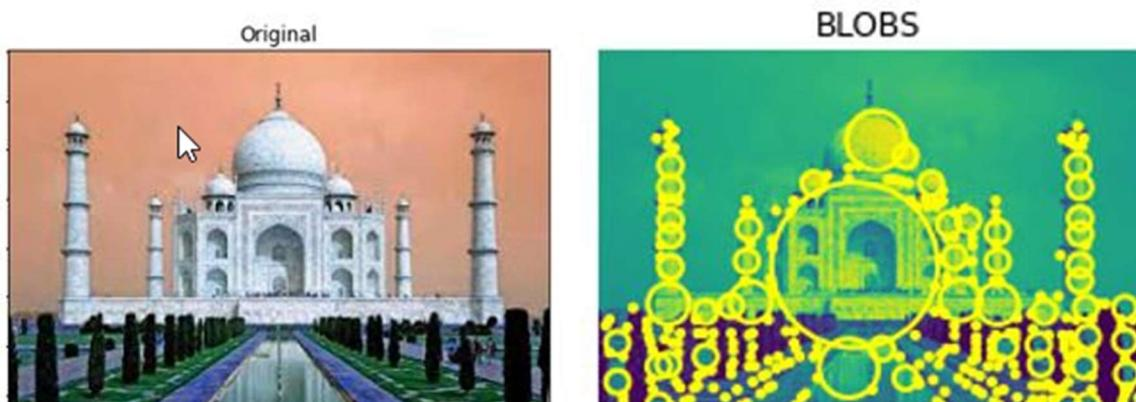
Slika 13. Primjer određivanja područja jednakih značajki sa slike primjenom *Blob Detection* algoritma [11]
