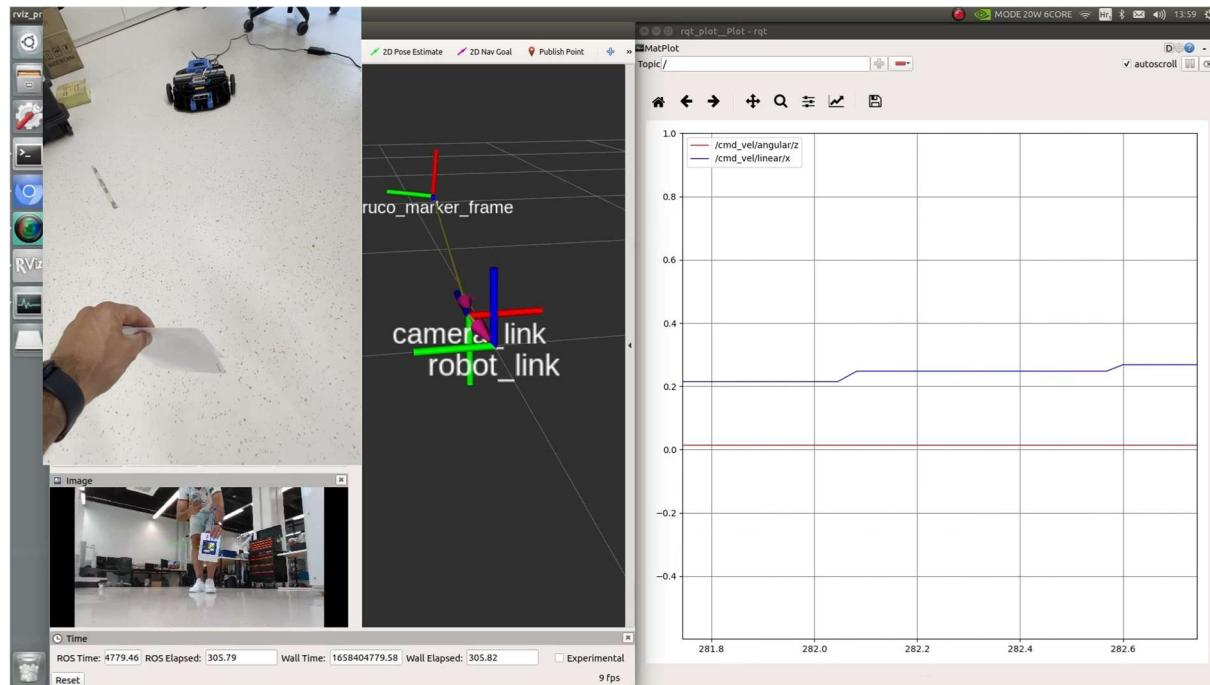
**Slika 52. Provodenje algoritama praćenja na mobilnom robotu**
