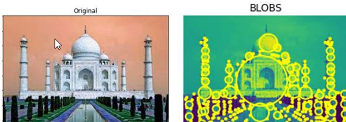
Slika 13. Primjer određivanja područja jednakih značajki sa slika primjenom Blob Detection algoritma [11]
