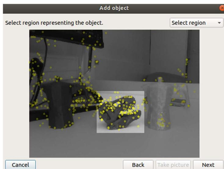
Slika 25. Postupak dodavanja novog objekta detekcije korištenjem čvora *find\_object\_2d*
