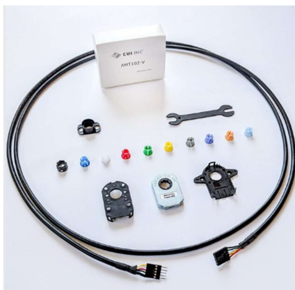
Slika 40. prikaz korištenog enkodera CUI AMT10E2-V [30]
