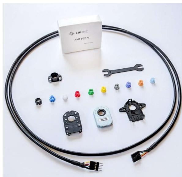
Slika 40. prikaz korištenog enkodera *CUI AMT10E2-V* [30]
