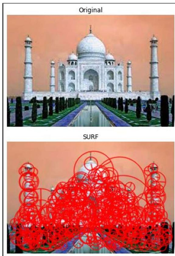
**Slika 12. Primjer podudaranja značajki sa slikom primjenom SURF algoritma[11]**
