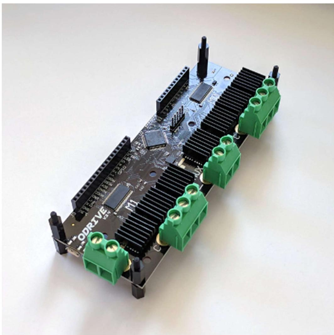
Slika 37. Prikaz korištenog *Odrive 3.6* sustava [31]
