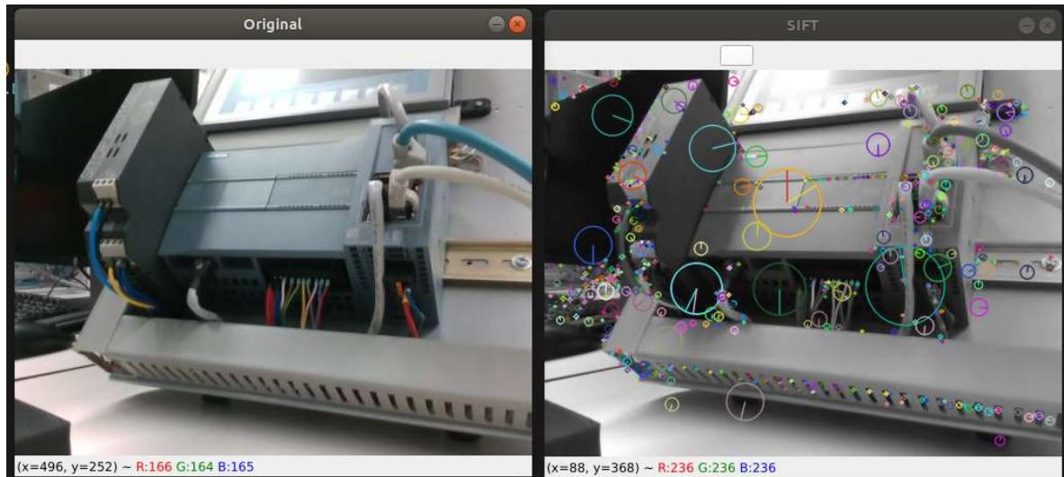
**Slika 11. Primjer digitalnog zapisa značajki primjenom *SIFT* algoritma**
