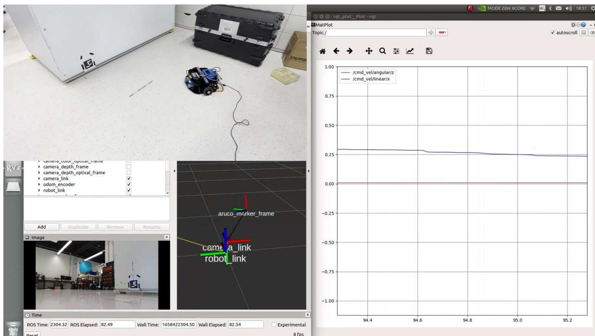
Slika 51. Provodenje algoritama pozicioniranja na mobilnom robotu
