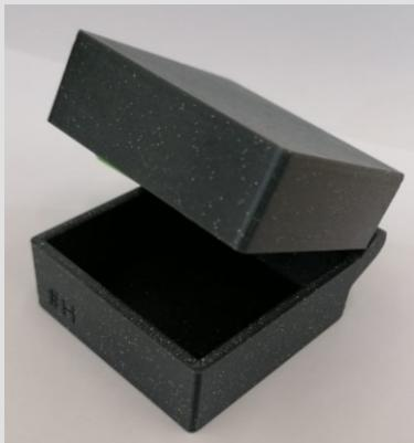
Odabirom odgovarajuće zračnosti između dijelova sklopa omogućena je izrada sklopova u jednom printu bez potrebe za sastavljanjem dijelova. Minimalna potrebna zračnost potrebna je kako ne bi došlo do spajanja slojeva dijelova.
