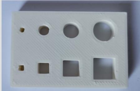
Odabirom veličine dimenzije rupa utječemo na dimenzijsku točnost i kvalitetu izrade. Rupe pre malih dimenzija ispasti će deformirano i samim time izgubiti će svoju dimenzijsku točnost.
