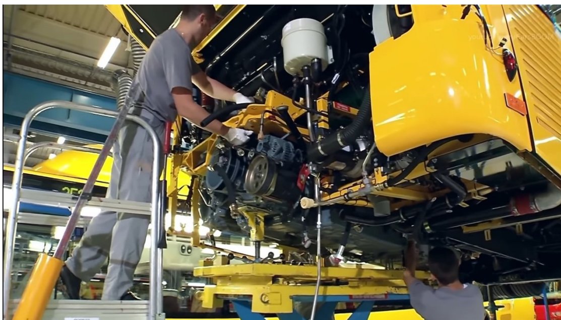
Slika 4. Pozicioniranje motora unutar autobusa, MAN tvornica, Poljska [3]
