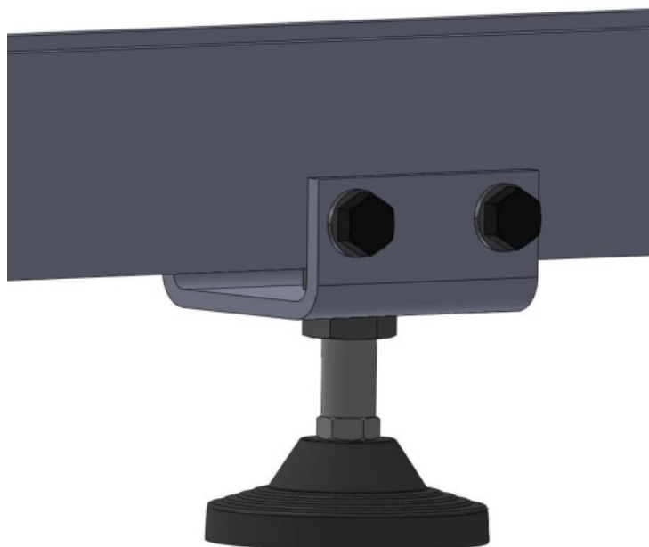
Slika 39. Spoj stopa za niveliranje i HEB profila
