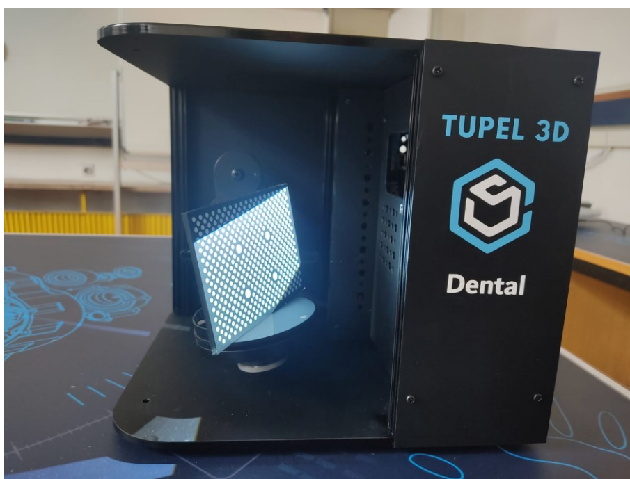
Slika 9. Kalibracija Tupel 3D Dental Scannera
